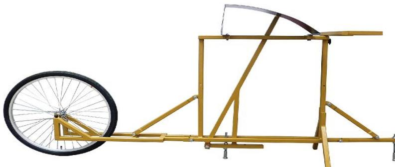
Figura 11. Instrumento del rugosímetro de Merlín.
