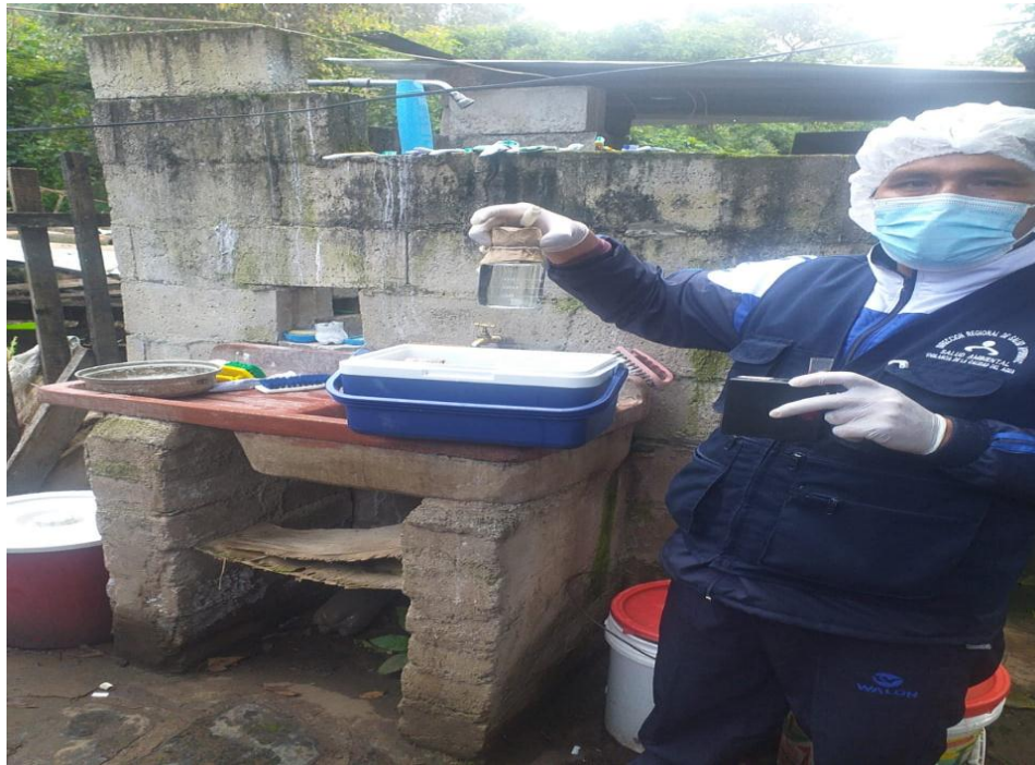
Verificación y recojo de muestra bacteriológico por ausencia de cloro
