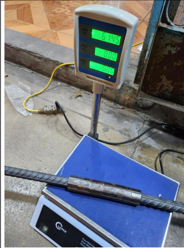
En la fotografía se puede observar el pesado de las muestras ensambladas.
