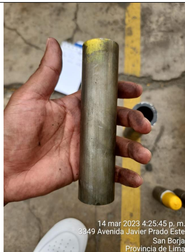
En la imagen se observa a detalle un conector mecánico a presión de \frac{3}{4} "
