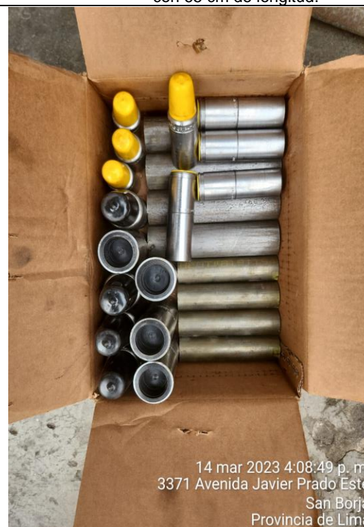
En la fotografía se observa los conectores mecánicos a presión tipo 2 y a presión con rosca tipo 2.
