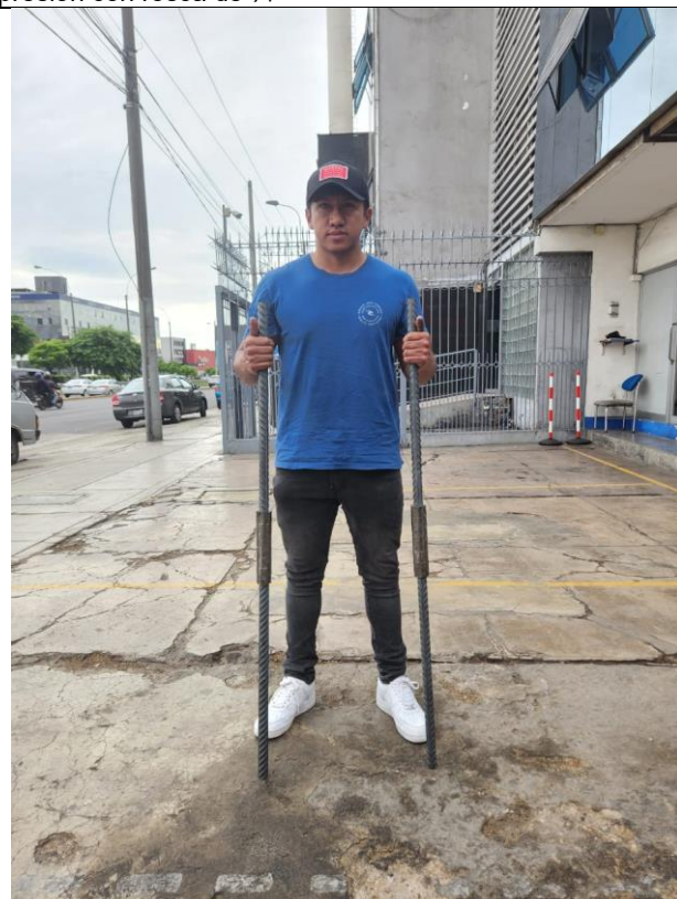
En la fotografía se observa los empalmes con conector mecánico a presión tipo 2 de 1" ya ensamblados.
