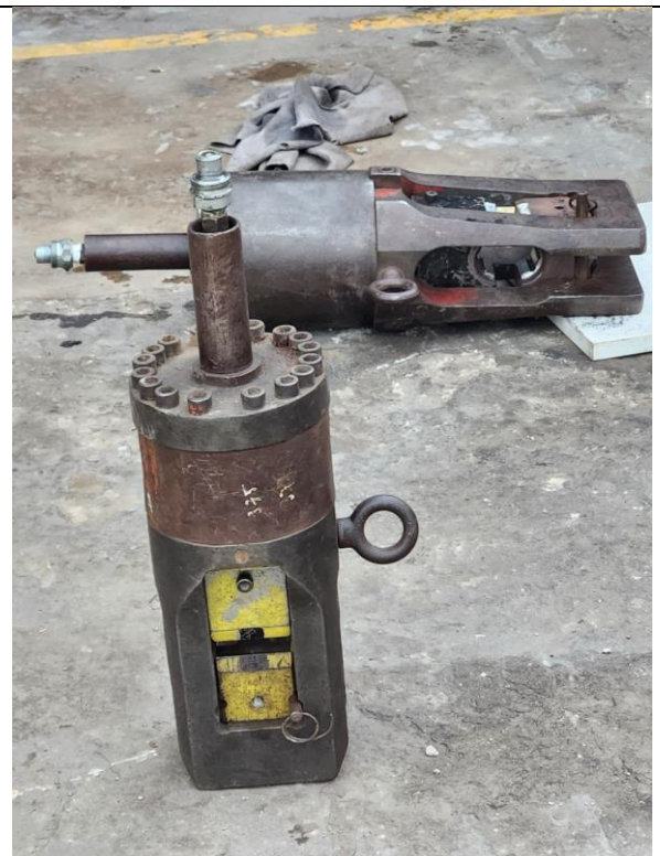
En la fotografía se puede apreciar la prensa hidráulica utilizada para em prensado de los conectores.
