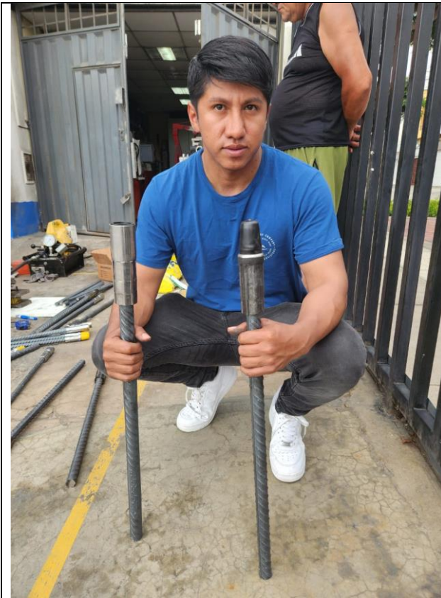
En la fotografía se puede observar la barra de acero de refuerzo de 1" ensamblada con conector mecánico a presión con rosca.
