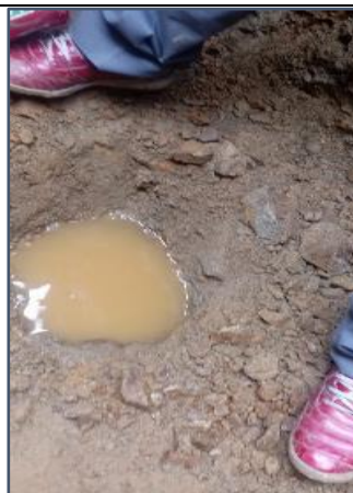
Fotografía. 44: Realizando la prueba de infiltración, para verificar el tipo de suelo y el tiempo que tarda para infiltrar el agua.
