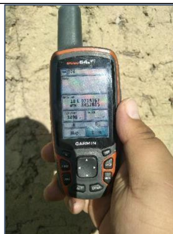
Fotografía. 36: Toma de puntos y/o coordenadas de las viviendas de los usuarios del sistema de agua potable.
