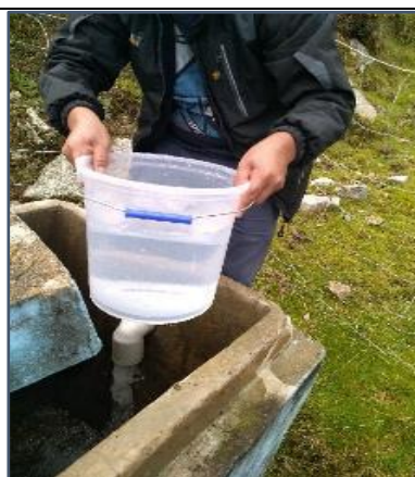
Fotografía. 46: Muestra de la medida del agua en balde transparente de 10 litros
