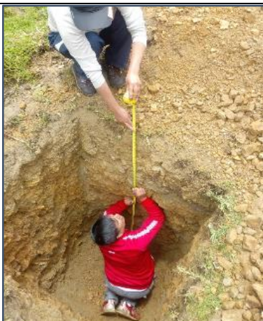
Fotografía. 43: Tomando las medidas de pozo para realizar el análisis de infiltración.
