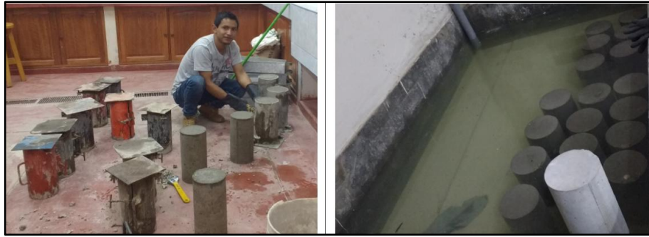
Posteriormente pasados las 24 hrs se desmoldan los testigos de concreto para ser sumergidas en agua (proceso de curado); hasta antes de las pruebas de rotura.
