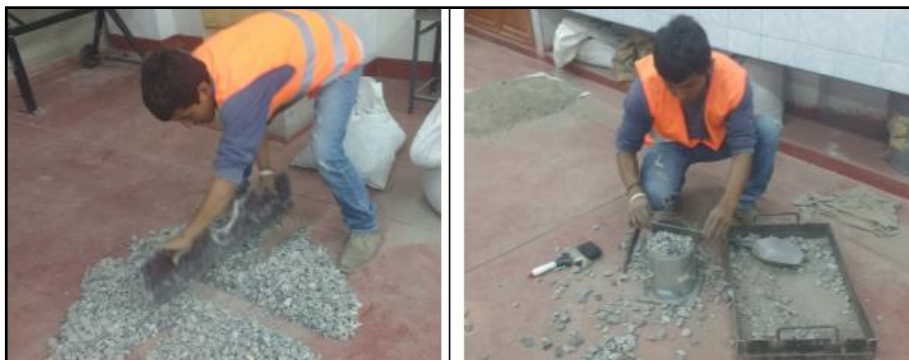
Imagen 6. 22 Cuarteo del agregado global y enrasado del material en el molde.
