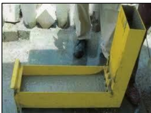
Imagen 2. 5 Descripción de los equipo caja "L" para ensayar el concreto en estado fresco.
