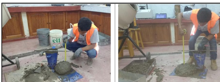
Se realiza la prueba de control del asentamiento, de la muestra diseñada.
