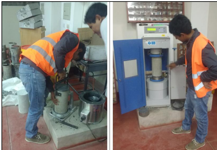
Proceso de capeo de las testigos junto a la olla de fusión del azufre durante 1 hora lado (Izquierdo), etapa de rotura del testigo de concreto capeadas con azufre lado (derecho).
