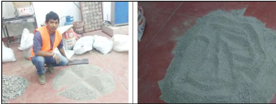
Imagen 6. 7 El agregado fino de la cantera Aymituma, material cuarteado para realizar los ensayos.
