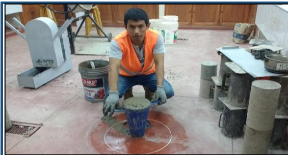
Concreto autocompactante en el cono de abrams invertido dentro del circulo de 55 centimetros.
