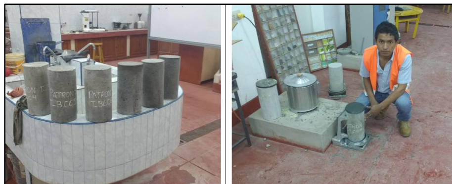
Se extrae los testigos para ser capeadas con el azufre diluido (capín), y luego ser ensayadas en la máquina de compresión simple.
