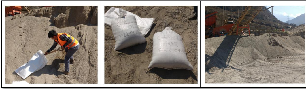
Imagen 6. 1 Extracción de muestra de agregado fino (arena) de la cantera Aymituma.
