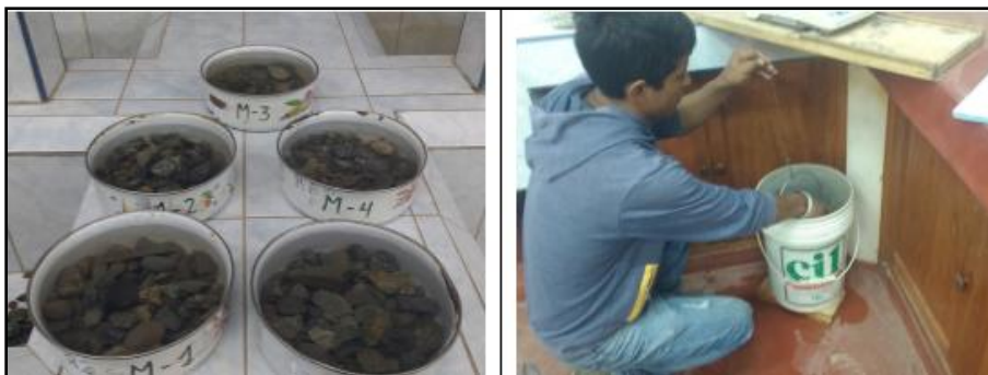
Imagen 6. 18 Saturado de las muestras representativas durante 24hrs para el ensayo de peso específico de masa y porcentaje de absorción.
