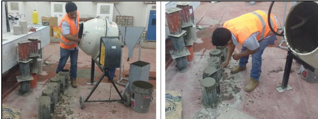
Luego de hacer el control en estado fresco al CAC se realiza los testigos en estado endurecido.
