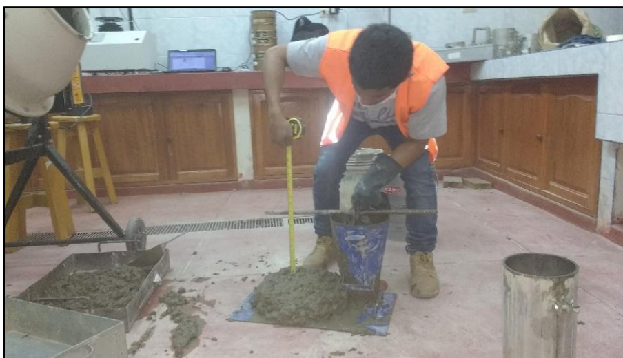
Imagen 7. 2 Control del asentamiento con el cono de Abrams, donde nos brinda un revenimiento dentro de los parámetros 6pulg – 7pulg.
