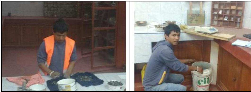
Imagen 6. 16 Secado superficial del agregado grueso con la ayuda de franela; muestra sumergida en el agua.
