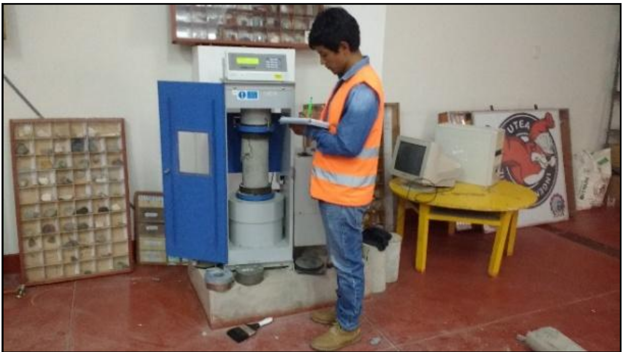
Toma de datos de la rotura de concreto.
