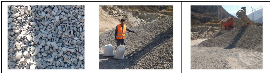
Imagen 6. 2 Extracción de muestra de agregado grueso (piedra) de la Cantera Aymituma.
