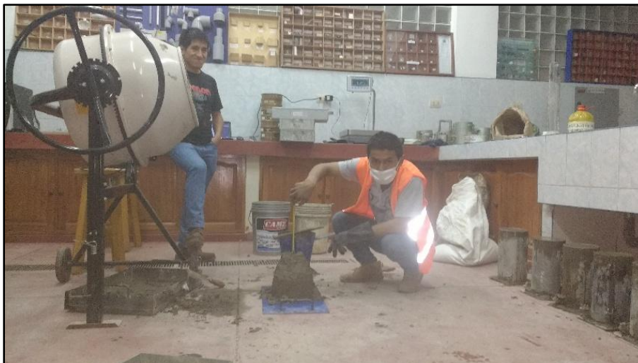
Imagen 7. 1 Control del asentamiento con el cono de Abrams, donde nos brinda un revenimiento dentro de los parámetros 3pulg – 4pulg.
