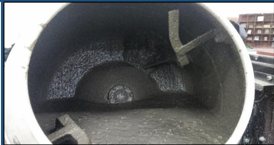
Resultado luego de echar el aditivo superplastificante, obtenemos un concreto fuido
