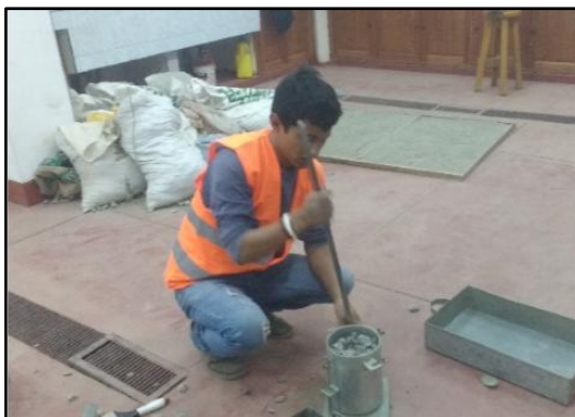
Imagen 6. 12 Varillando el agregado en el molde de peso unitario
