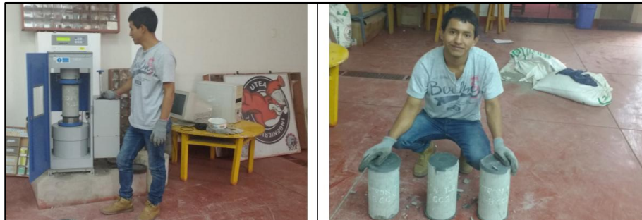
Rotura de briquetas en la máquina de compresión simple lado (Izquierdo), briquetas capeadas con azufre lado (derecho).
