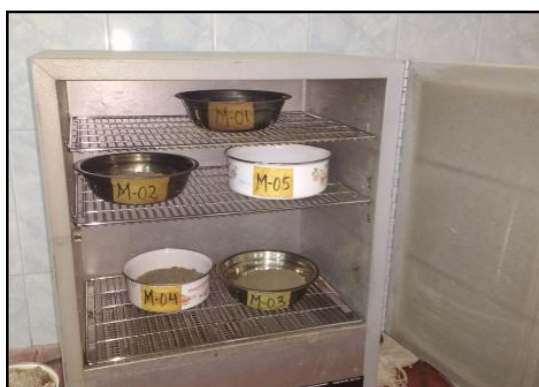
Imagen 6. 20 Secado de las muestras representativas del agregado fino y grueso.
