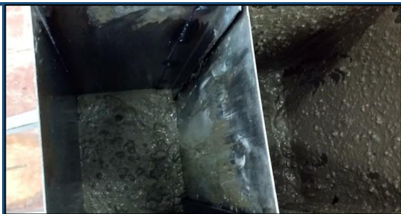
Niveles del concreto autocompactante luego de la prueba
