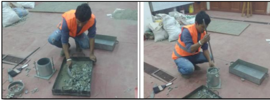
Imagen 6. 21 Procedimiento del ensayo de peso unitario compactado del agregado global de la cantera Quispe.
