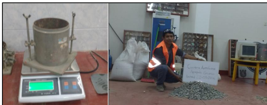
Imagen 6. 14 Peso del molde y muestra representativa para realizar el ensayo
