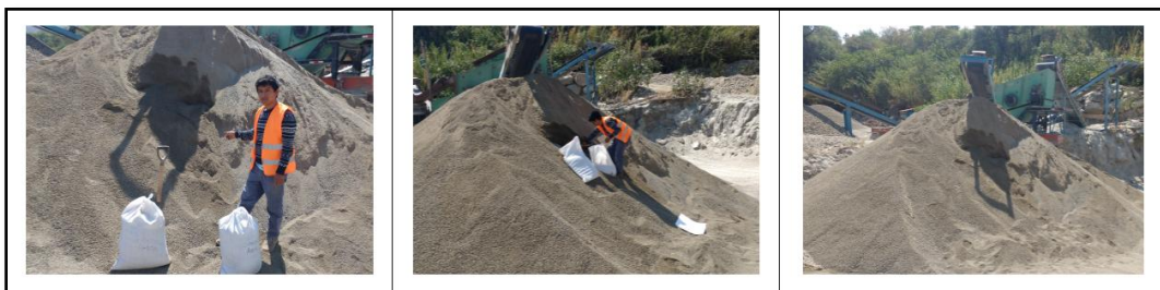
Imagen 6. 3 Extracción de muestra de agregado fina (arena) de la Cantera Quispe.
