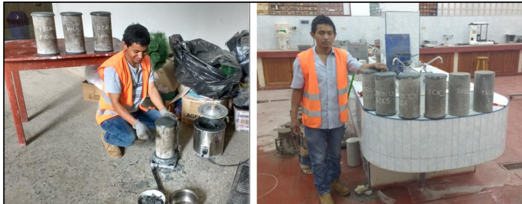
Se extraen los testigos de CAC y se seca la superficie para que luego se pueda capear con azufre diluido.
