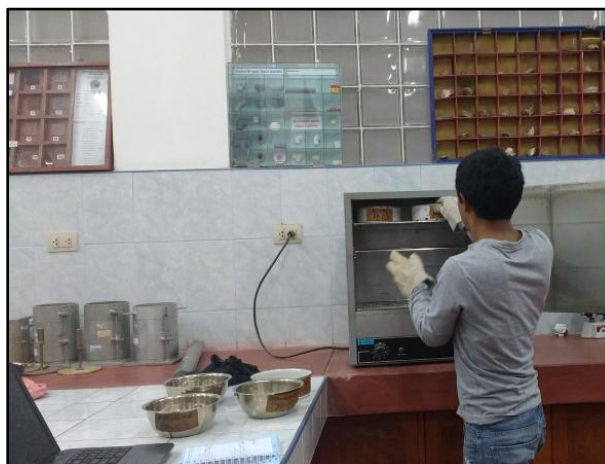
Imagen 6. 10 El agregado fino y grueso secando final del material lavado.
