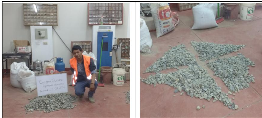
Imagen 6. 6 El material grueso extendido con su identificación en lado izquierdo, el material cuarteado para realizar los ensayos.
