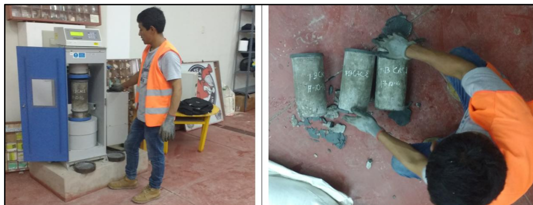
Se inserta cada uno los testigos capeados en el interior de la máquina de compresión simple.
