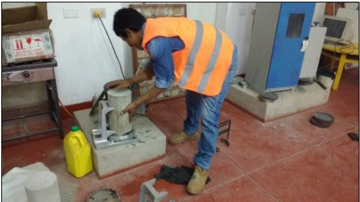
Enrrazado del testigos de concreto con azufre.
