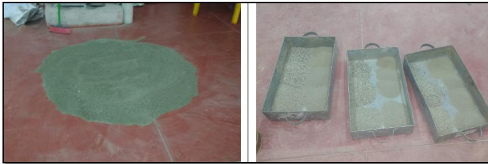
Imagen 6. 5 El material fino extendido para luego ser cuarteado lado izquierdo, las tres muestras tamizadas en las mallas normalizadas.
