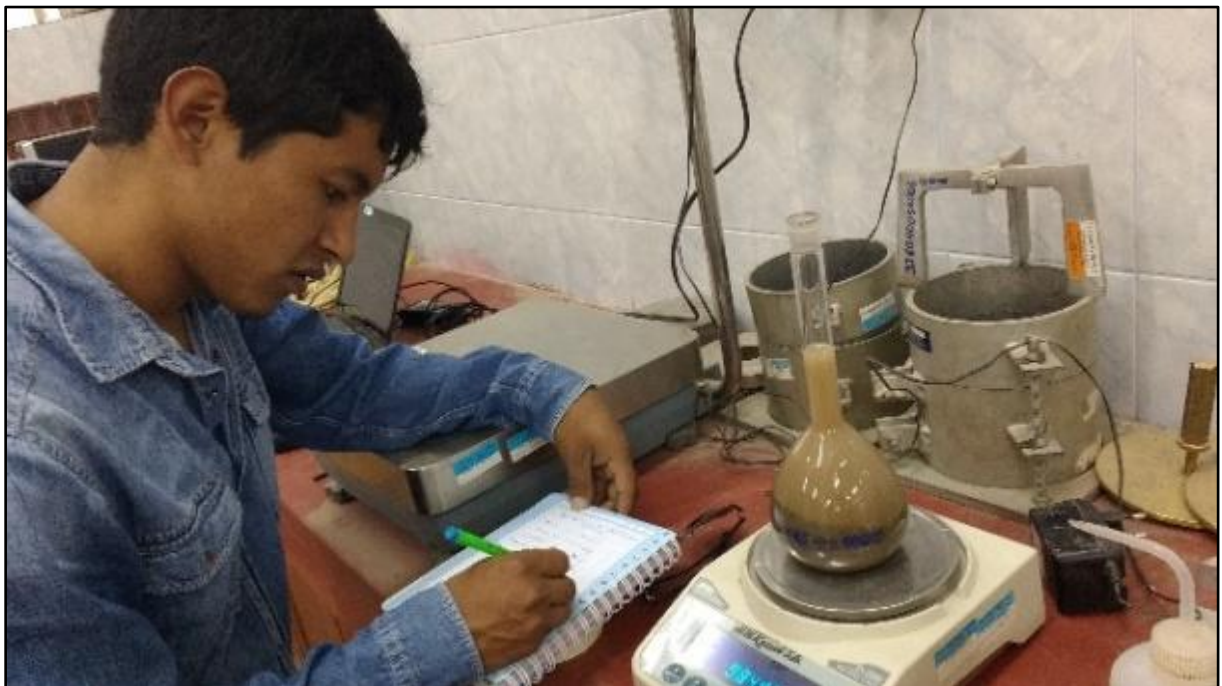
Ensayo de peso específico de agregado fino.
