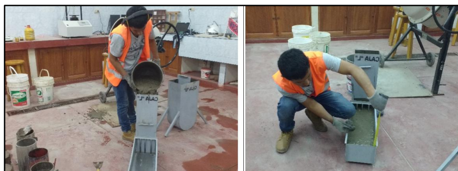
Se extrae muestra representativa de concreto autocompactante, y luego verter el CAC en la columna vertical del molde antes tener que estar cerrada la compuerta.
