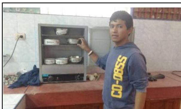
Imagen 6. 19 Extracción de la muestra del horno después de 24 hrs.
