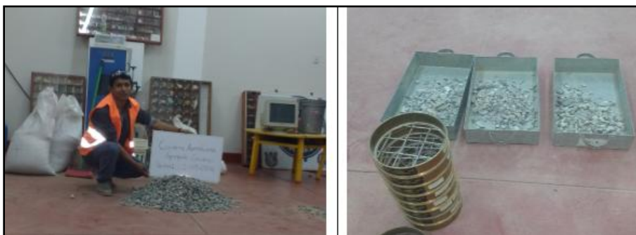
Imagen 6. 8 El agregado grueso de la cantera Aymituma material cuarteado para realizar los ensayos.
