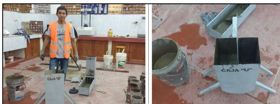
Ensayo de capacidad de paso que se ensaya en el molde “U”, por un lado observamos la muestra en el molde, y en el otro el descenso y ascenso de la muestra.
