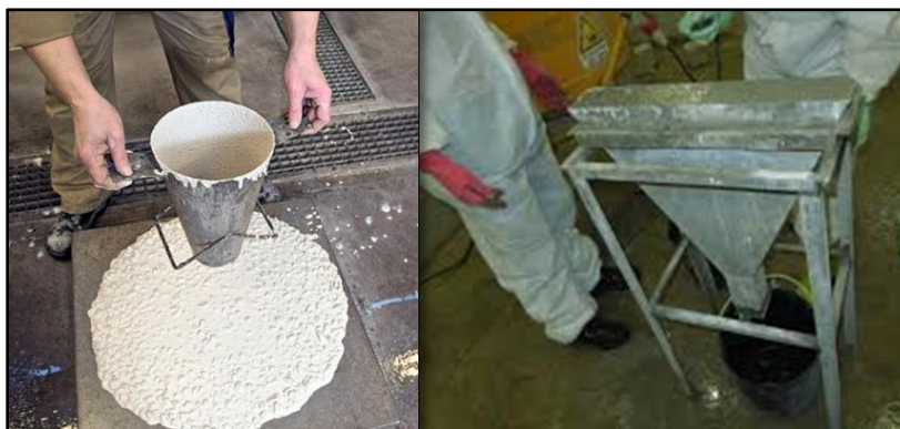
Imagen 2. 4 Descripción de los equipos slump flow, caja "V" para ensayar el concreto en estado fresco.
