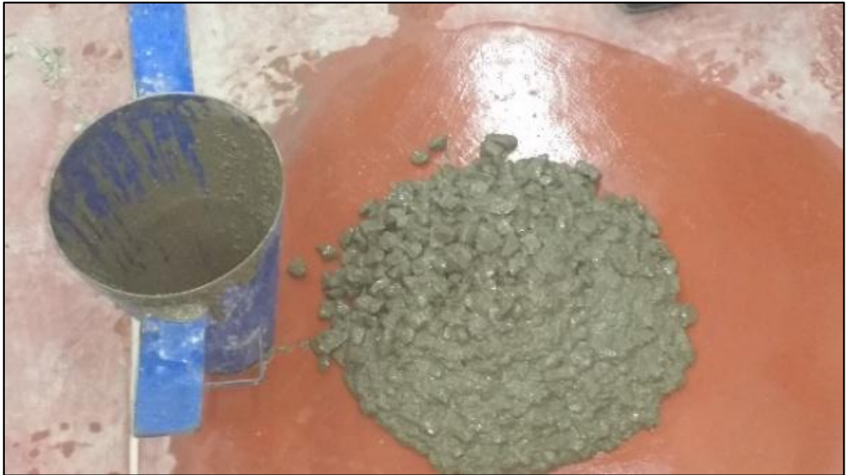
Primera prueba del concreto autocompactante.
