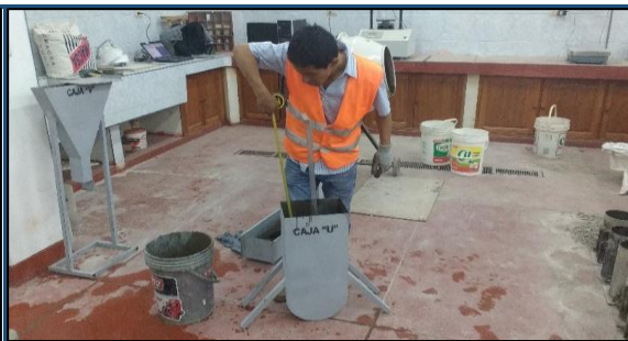
Medimos la altura de descenso y ascendio el concreto autocompactante en la caja "U"
