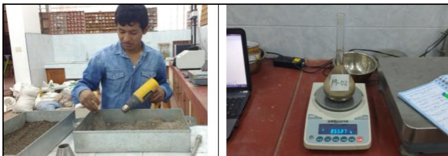
Imagen 6. 15 Secado superficial del agregado fino con la ayuda de secadora y el cono.
