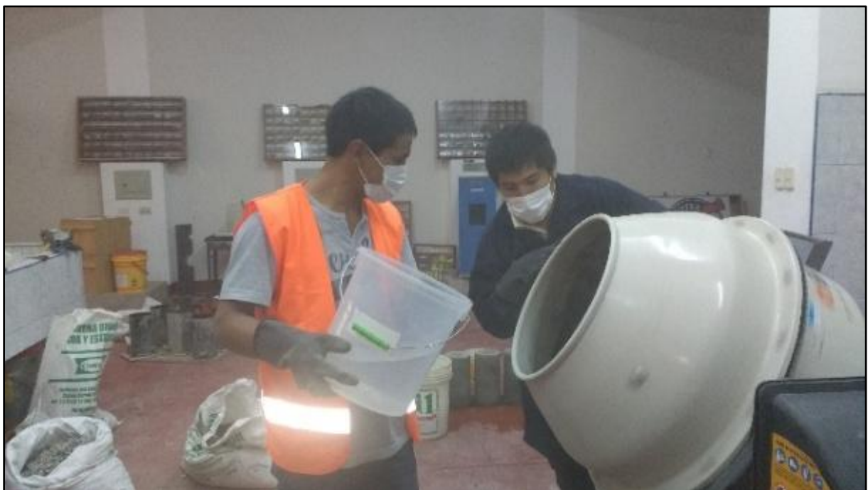
Preparado de la muestra de concreto en laboratorio.
