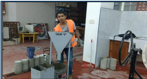
Conteo de tiempo en la prueba de la caja en "V"
