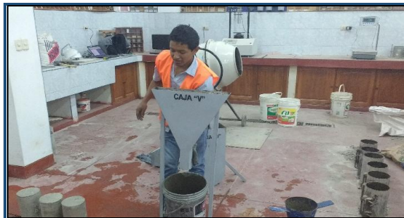
Dejamos que el concreto repose durante 5min para luego observar su comportamiento
