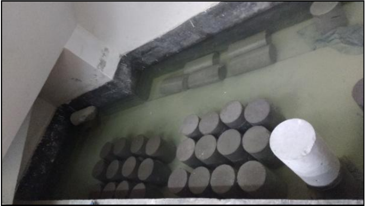
Curado de briquetas (testigos de concreto).
