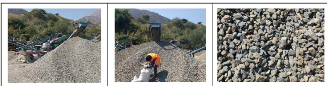
Imagen 6. 4 Extracción de muestra de agregado gruesa (piedra) de la Cantera Quispe (Pachachaca).
