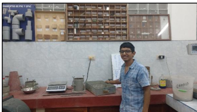
Imagen 6. 13 La muestra de agregado pesada en el molde de peso unitario.
