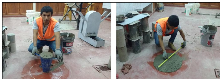
Ensayo de extensión de flujo con el cono de Abrams invertido donde se mide la extensión de flujo y el tiempo que alcanza los 50 cm.
