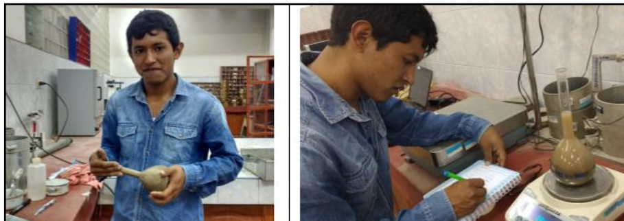
Imagen 6. 17 Eliminación de vacíos en el agregado fino para calcular el peso específico de masa.
