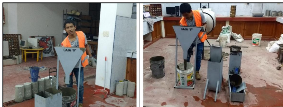
En molde “V” se realiza el ensayo de capacidad de fluidez por lugares estrechos.
