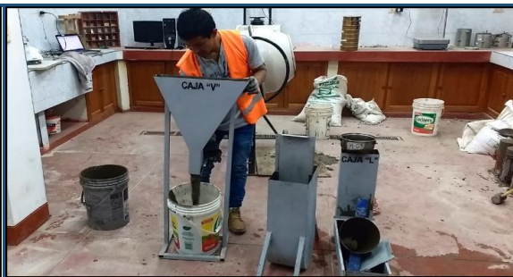
Sujetamos compuerta de salida para dejar fluir el concreto autocompactante
