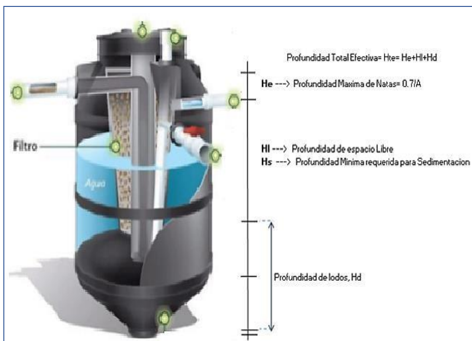
Figura 43. Datos de biodigestor de 1300 litros.
