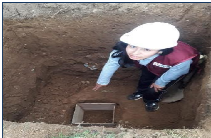
Figura 31. Preparación de cubeto de 0.30x0.30x0.30 m Fuente: Elaboración propia.
