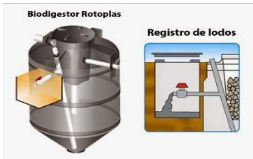
Figura 42. Caja de registros de lodos.
