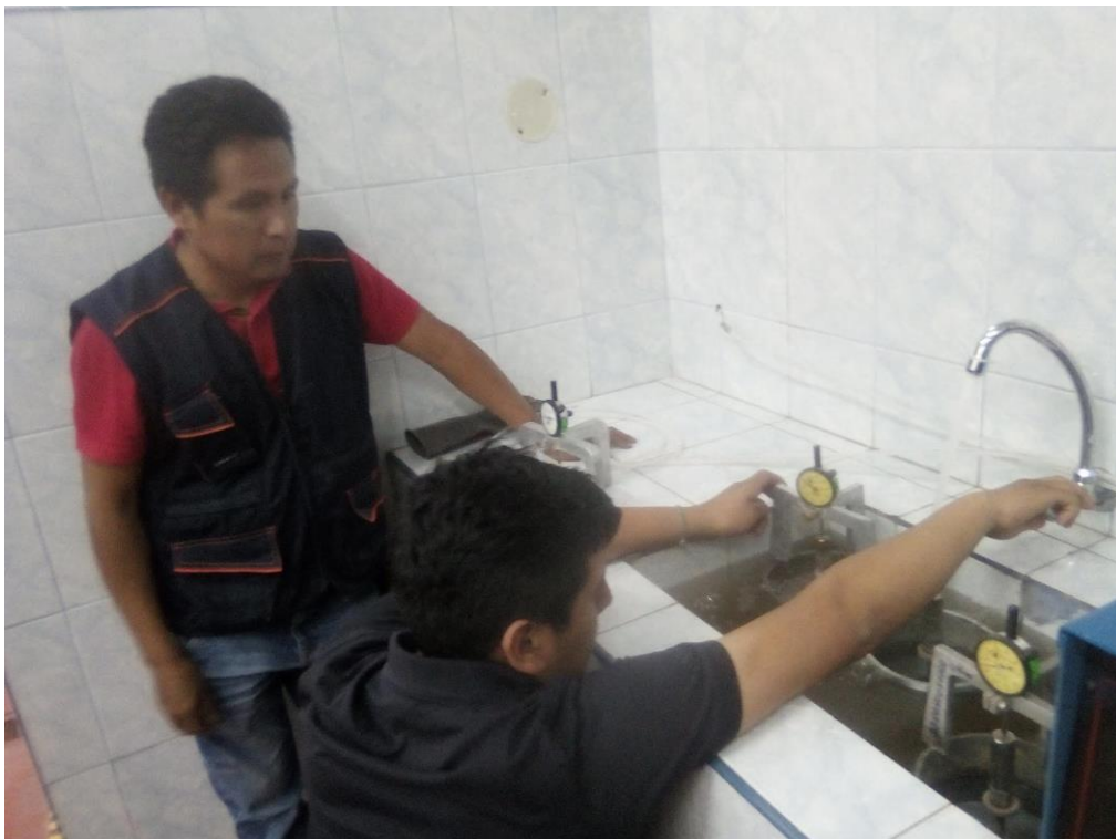
Calibrado de la muestra más molde para la prueba de relación de soporte de california (CBR) con muestra de la cantera 01.
