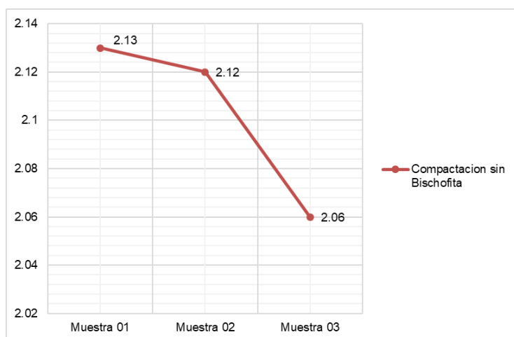
Ensayo de Compactación sin Bischofita en Calicata 09
