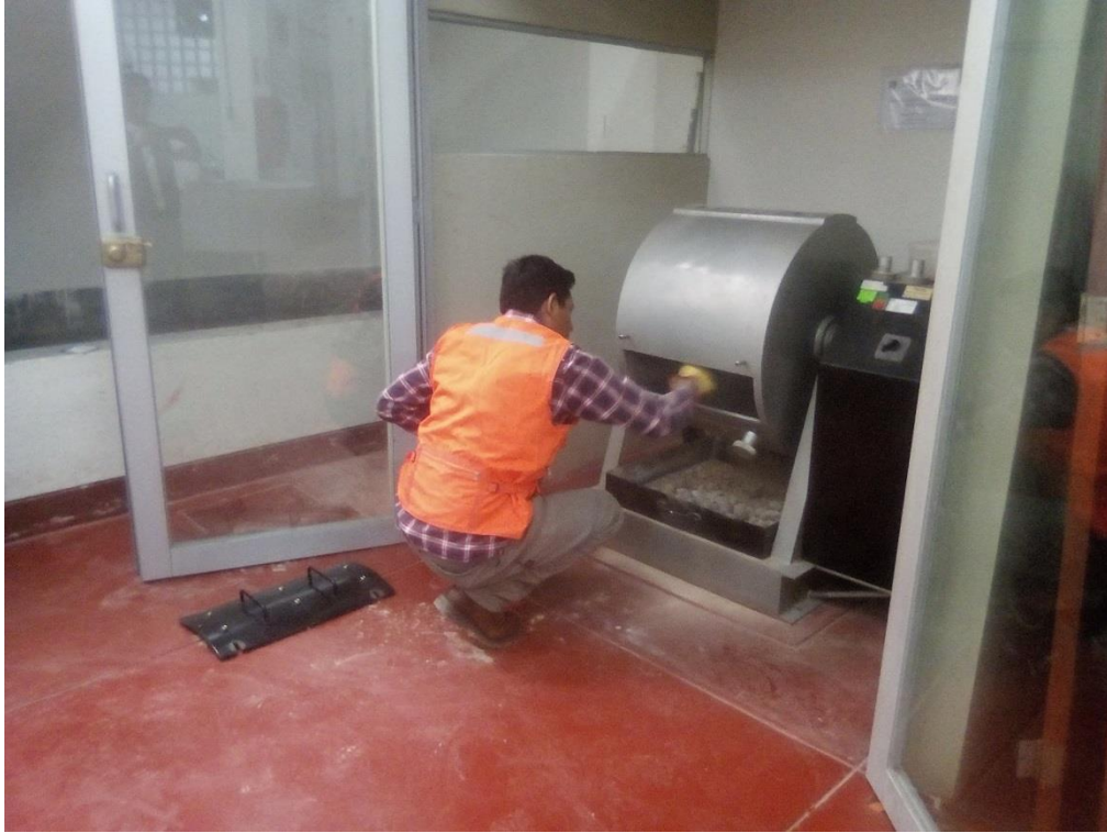
Realizando la prueba de desgaste por medio de la máquina de los ángeles con muestra de la calicata 09 según MTC E-207 basado en las normas ASTM C-131 y C-535
