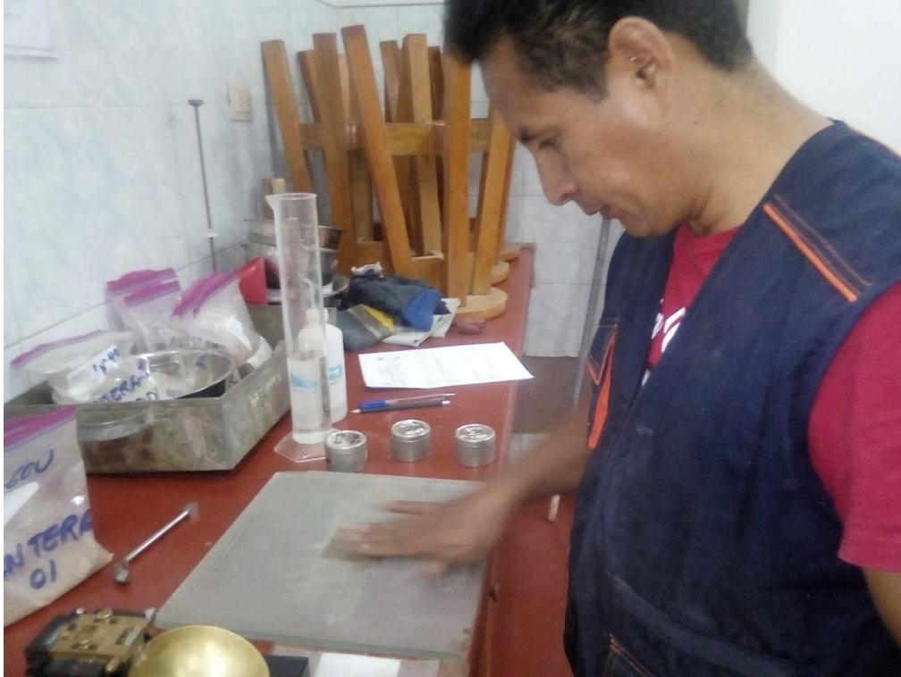
Preparación de la muestra para límite plástico.
