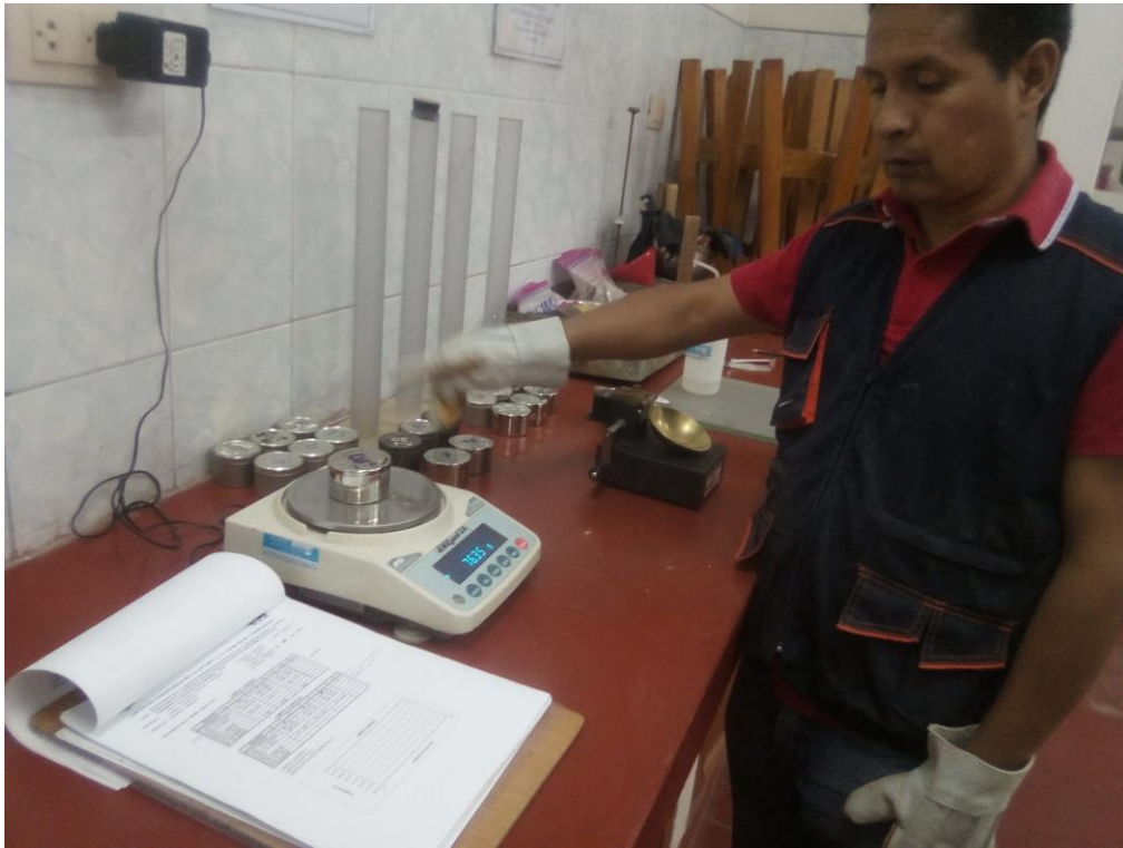
Realizando la colocación de la muestra fracturada en las capsulas para poner al horno durante 24 horas a 105°C.
