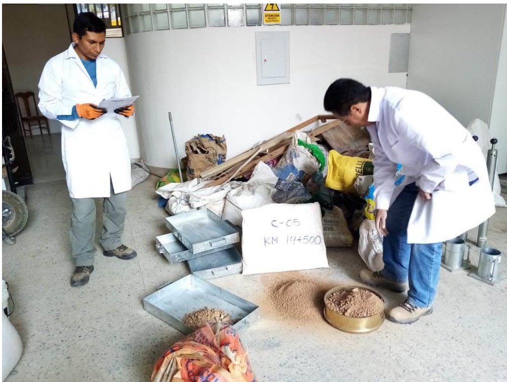
Tamizado de muestra para realizar prueba de compactación relaciones humedad - densidad (Próctor modificado)
