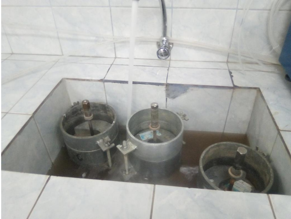
Sumergido de la muestra más molde para la prueba de relación de soporte de california (CBR) con muestra de la cantera 01.
