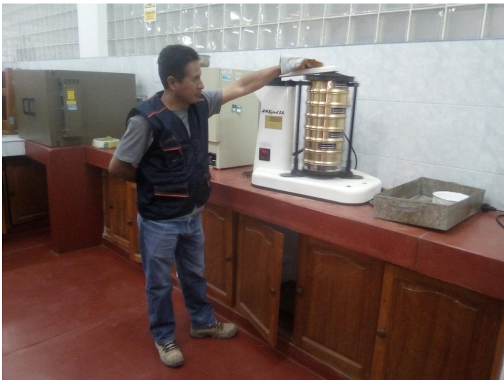
En esta vista se observa realizando el tamizado para el análisis granulométrico
