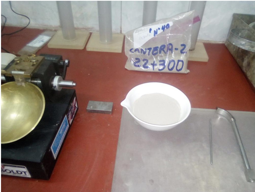
Muestra que pasa tamiz n° 40 para realizar las pruebas de consistencia de la calicata 10 del km 22+300
