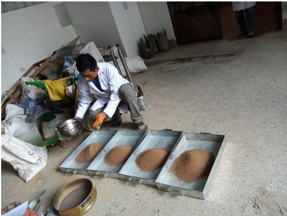
Muestra pesada para combinar con agua a diferentes porcentajes para mostrar la curva entre densidad seca y contenido de humedad.
