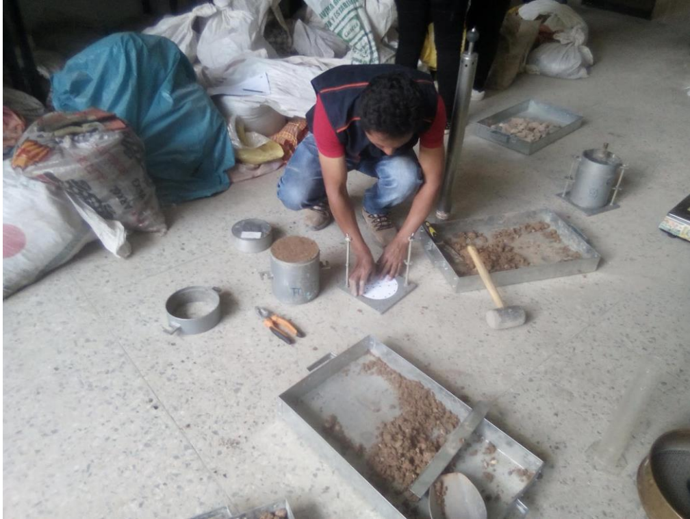
Colocación de papel filtro para la prueba de relación de soporte de california (CBR) con muestra de la calicata 09.
