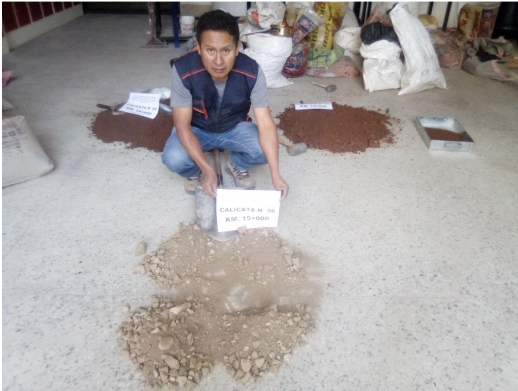
Cuarteo de la muestra calicata n° 6 km 15+000 para realizar el análisis de granulometría por tamizado.
