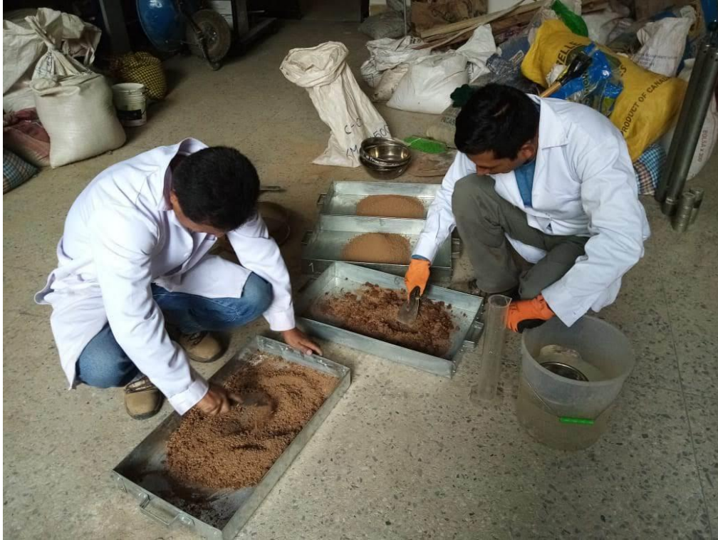
Preparación de la muestra según para contenido de humedad óptima y densidad máxima seca.
