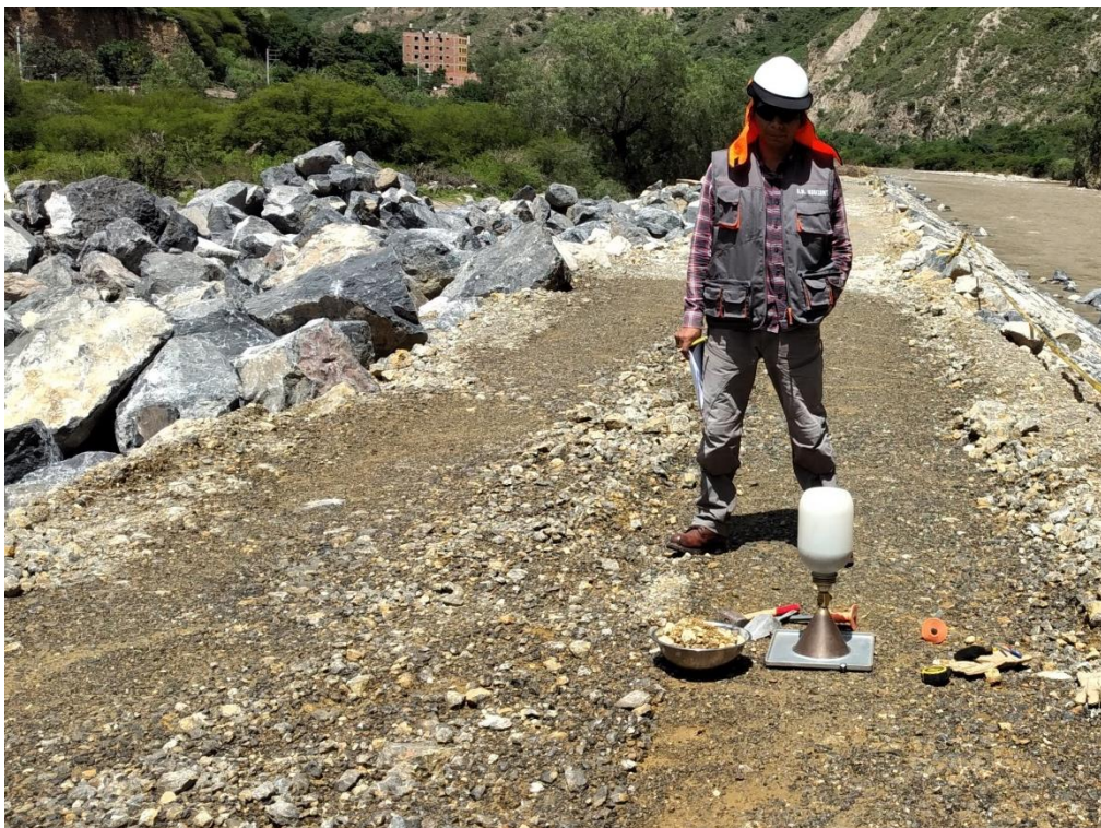
Prueba in situ método cono de arena con bischofita al 4% según MTC E 117 basado en las normas AASHTO T191 y ASTM D1556
