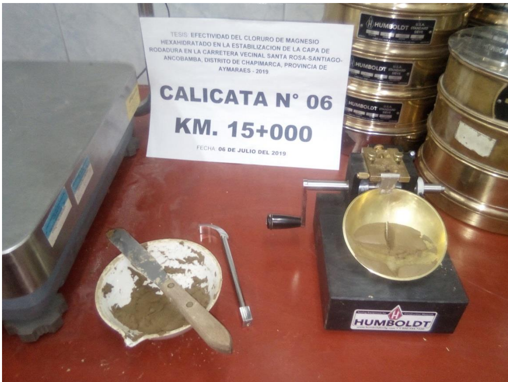
Se realiza la prueba para límite líquido en la cuchara de Casagrande
