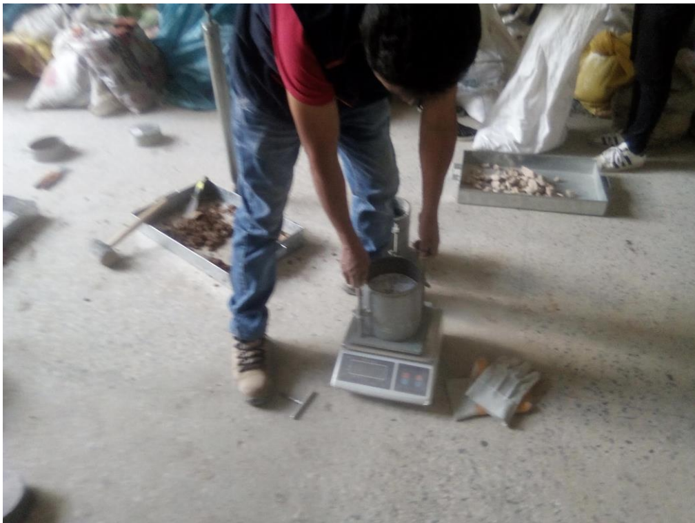
Pesado de la muestra más molde para la prueba de relación de soporte de california (CBR) con muestra de la calicata 09.
