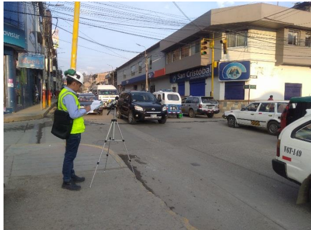
Figura 9: Medición de ruido ambiental en las intersecciones.
