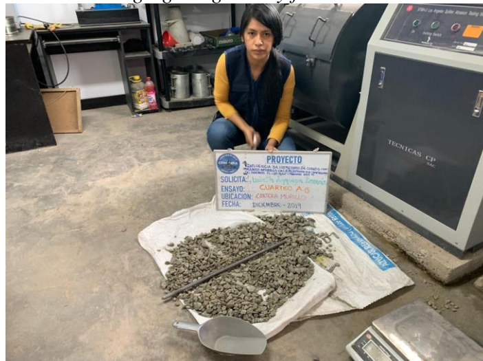
Figura 3 Muestreo del agregado grueso y fino.
