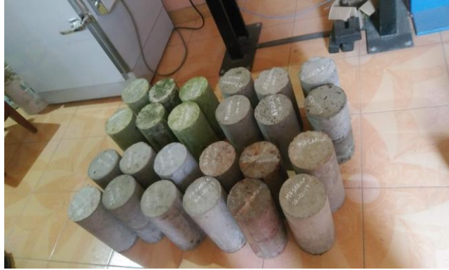
Figura 11 Testigos de concreto de edad de 7 días.
