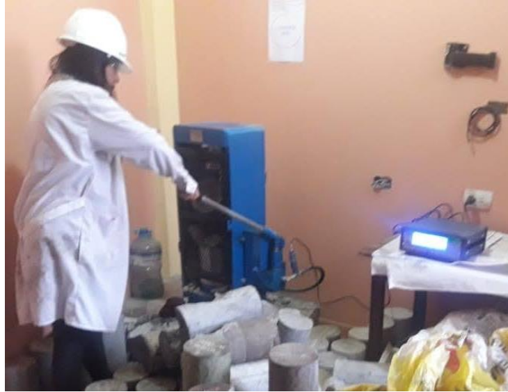
Figura 12 Ensayo de resistencia compresión del concreto.
