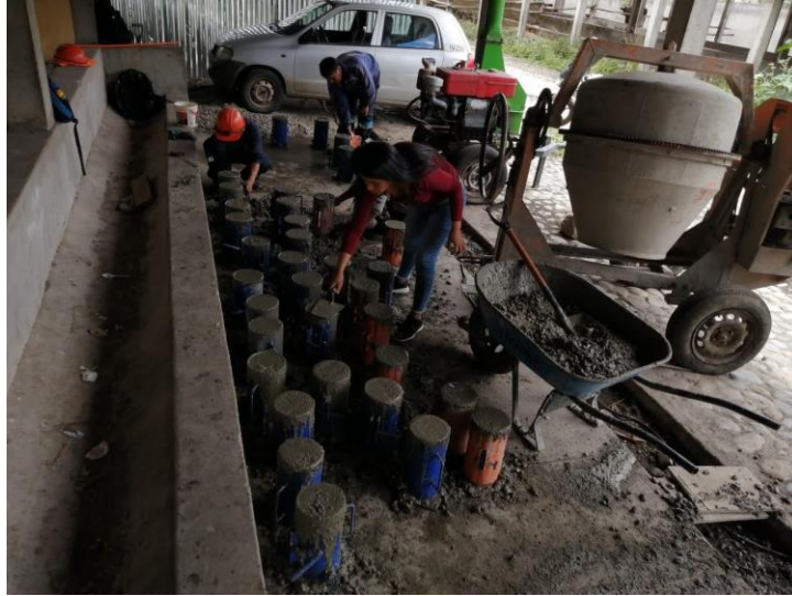
Figura 5 Elaboración de los testigos de concreto.
