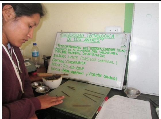
Tesista realizando el ensayo de limite plastico con suelo natural.
