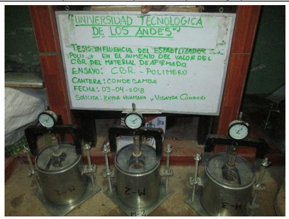
Muestras compactadas a 56, 25 y 12 golpes, con sus diales respectivos para realizar lecturas de expansión.
