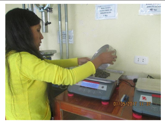
Peso de suelo retenido en los diferentes N° de mallas.
