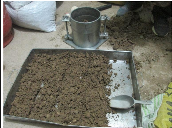
Mescla de suelo con 8% de contenido de agua, dividido en 5 partes para compactar en molde de proctor modificado.
