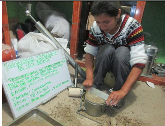
Compactacion de suelo cada 5 capas a 56 golpes cada una con pison manual.
