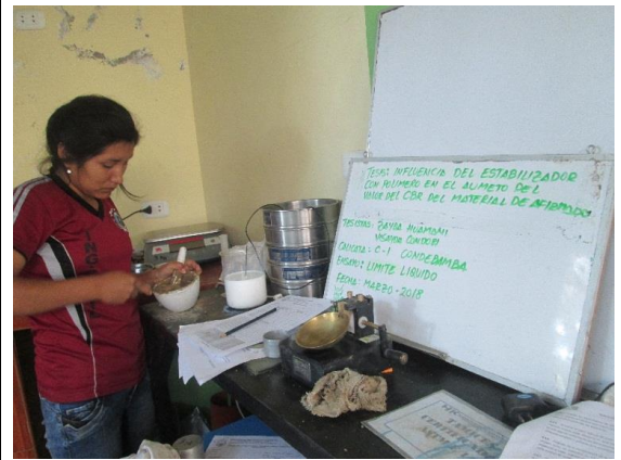
Tesista realizando limite liquido de suelo aplicando polímero.
