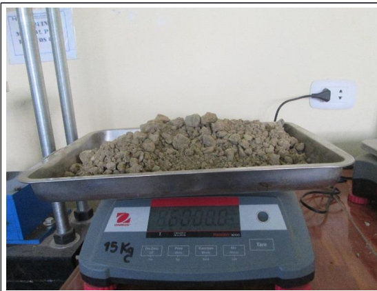
Seleccionando 6 kg de muestra de suelo para elección del tipo de metodo a utilizar en el Proctor Modificado.
