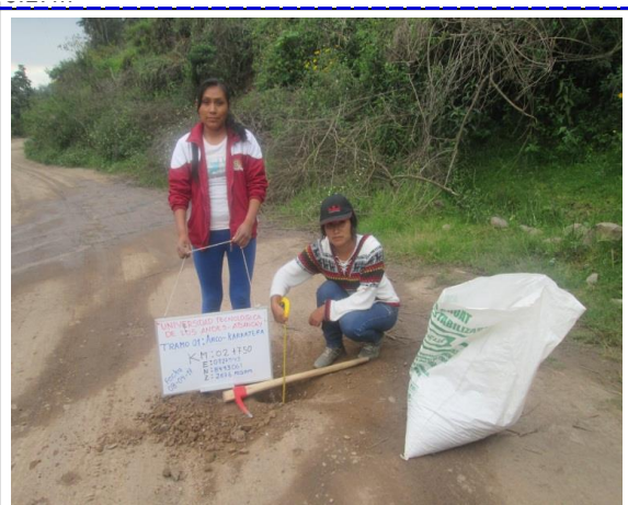
Km 2+750 : ancho de la via = 3.80 m, espesor de afirmado 0.22 m
