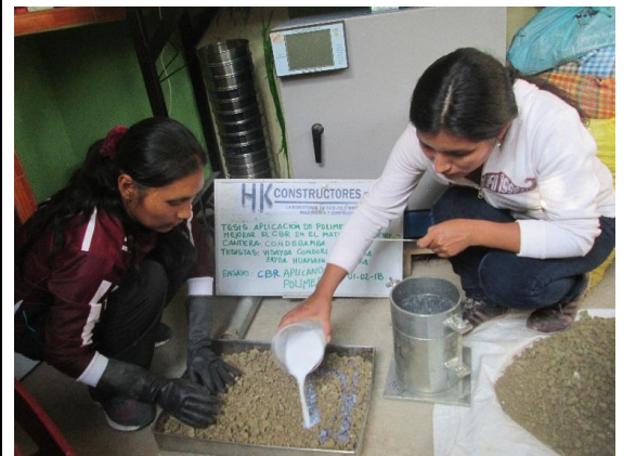
Muestra de 5 kg mezclado con 7.1 % de agua + polímero (OCH) para realizar el ensayo de CBR.
