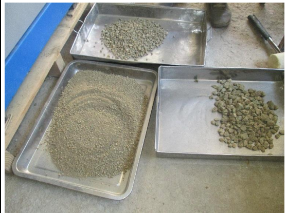
Muestras que pasan las mallas 3/4", 3/8" y N° 04, se realiza el ensayo de Proctor Modificado utilizando el metodo C.
