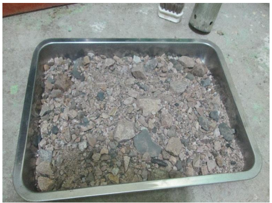
Sulo lavado y secado al horno para realizar ensayo granulometrico.
