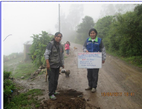
Km 11+750 : ancho de la via = 3.00 m, espesor de afirmado 0.16 m
