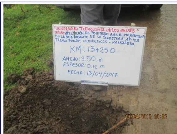
Km 13+250 : ancho de la via = 3.50 m, espesor de afirmado 0.12m
