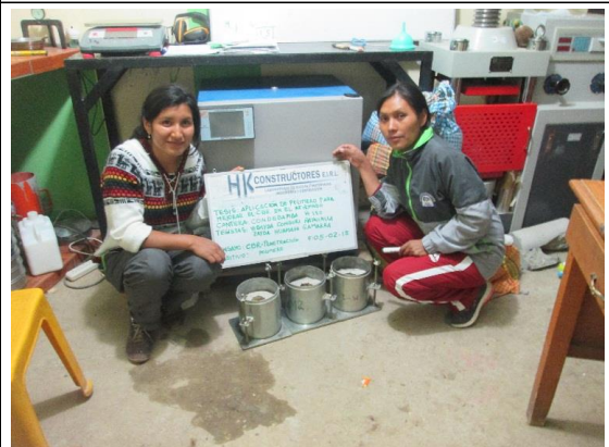
Muestra puesta en agua durante 4 días para poder realizar lectura de expansión.
