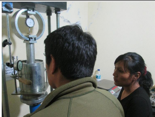
Colocando dial para lectura de expansión del suelo.
