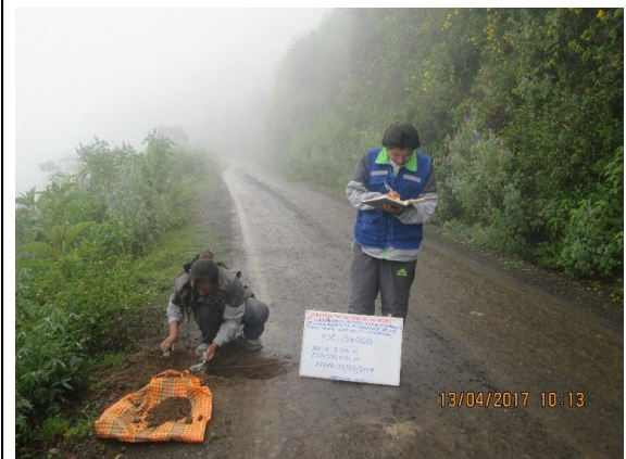
Km12+500 : ancho de la via = 3.50 m, espesor de afirmado 0.18m
