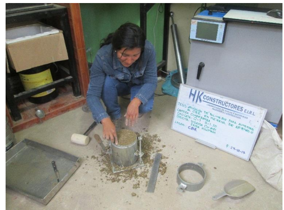
Corte y nivelacion con regla metalica de muestra sobrante.
