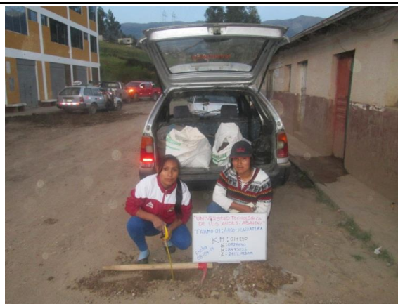
Km 1+250 : ancho de la vía = 4.10 m, espesor de afirmado 0.20m
