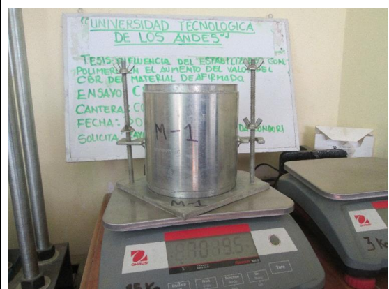
Pesado de molde con muestra compactada para determinar la densidad del suelo.
