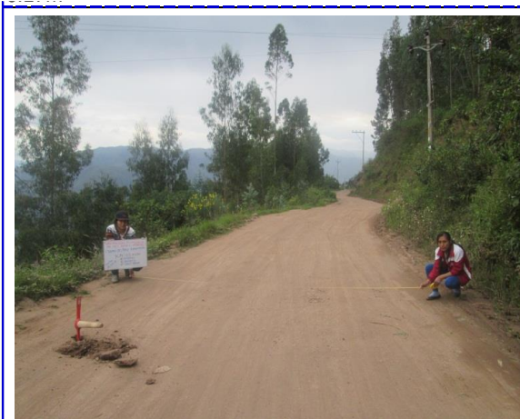
Km 2+500 : ancho de la via = 4.50 m, espesor de afirmado 0.27m
