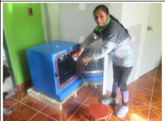
Tesista poniendo al horno muestras para determinar el contenido de Humedad a una temperatura de 110 Cº.
