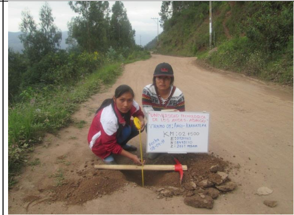
Km 2+000 : ancho de la vía = 3.70 m, espesor de afirmado 0.20m
