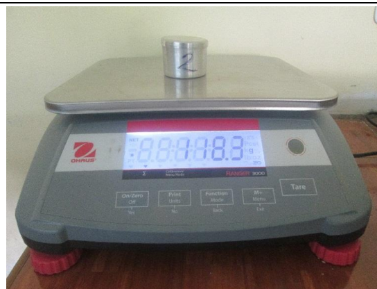
Peso de tara on suelo humedo para determinar contenido de humedad.
