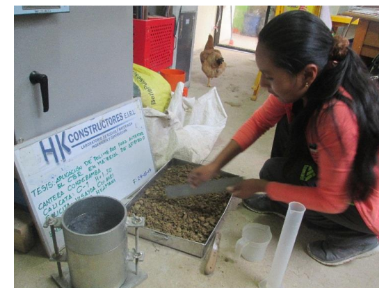
Muestra de 5 kg mezclada con 6.1 % de agua(OCH) para realizar el ensayo de CBR.
