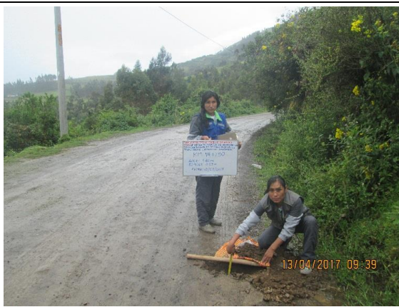
Km13+750 : ancho de la via = 4.00 m, espesor de afirmado 0.14 m
