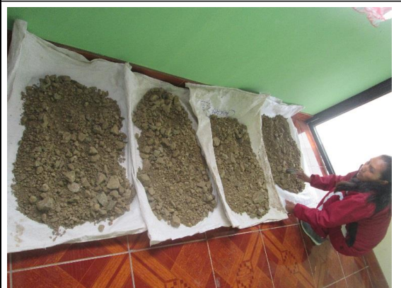
Tesista poniendo al horno muestras para determinar el contenido de Humedad a una temperatura de 110 Cº.
