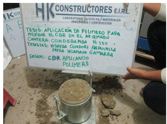
Compactacion de suleo cada 5 capas a 56, 25 y 12 golpes con pison manual.
