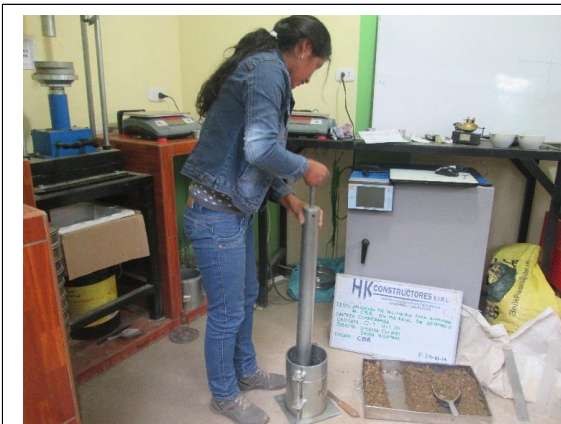
Compactacion de suelo cada 5 capas a 56 golpes cada una con pison manual.
