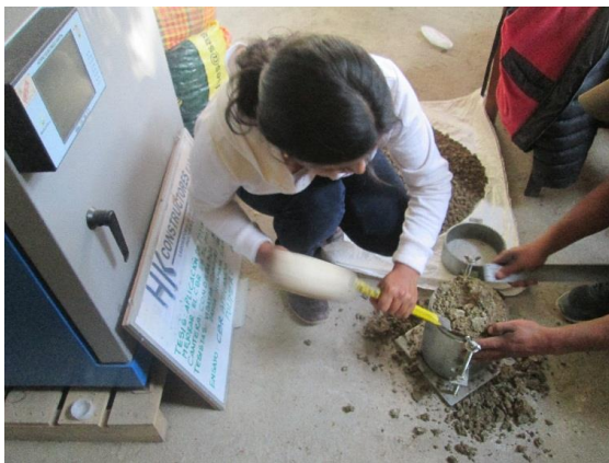
Colocando 1era capa de suelo mezclado con polimero en molde para CBR.
