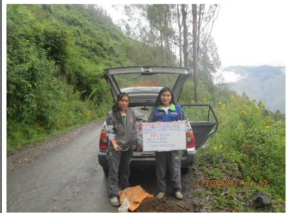
Km 6+750 : ancho de la via = 2.60 m, espesor de afirmado 0.14m
