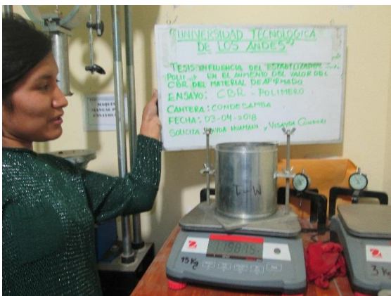
Pesando molde para realizar ensayo de CBR aplicando polímero.
