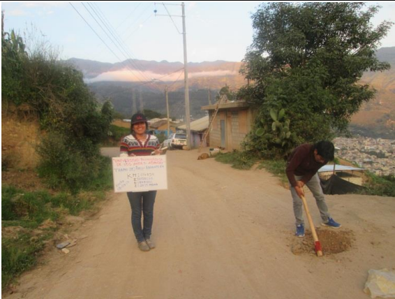
Km 1+250 : ancho de la vía = 4.10 m, espesor de afirmado 0.20m
