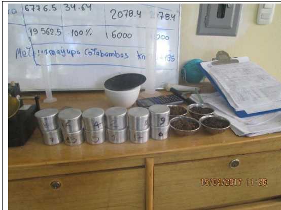
Taras pesadas para realizar ensayo de contenido de humedad en suelos alterados.
