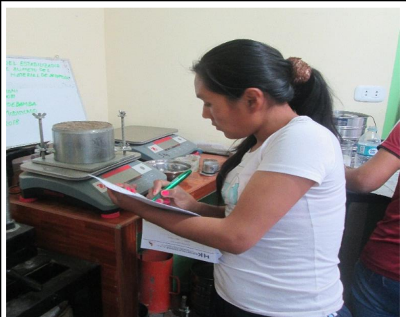
Pesando Molde con suelo compactado para determinar la densidad.
