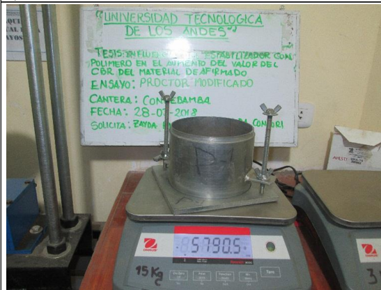
Seleccionando 6 kg de muestra de suelo para elección del tipo de metodo a utilizar en el Proctor Modificado.
