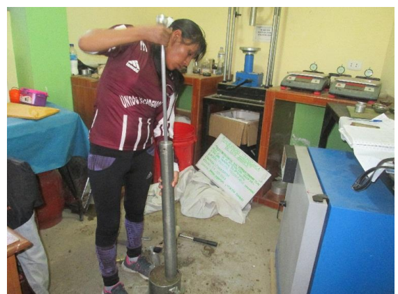
Compactacion de suleo cada 5 capas a 56, 25 y 12 golpes con pison manual.
