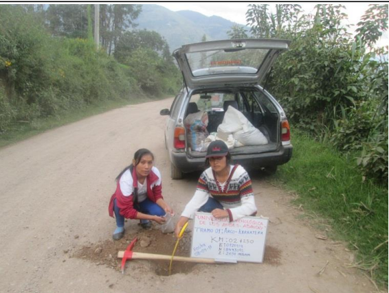
Km 1+750 : ancho de la vía = 3.50 m, espesor de afirmado 0.20m
