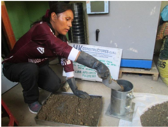
Colocando 1era capa de suelo mezclado con polimero en molde para CBR.
