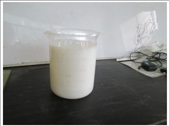
Mescla 1 polímero con 4 de H 2 O, para utilizar en ensayos de laboratorio.
