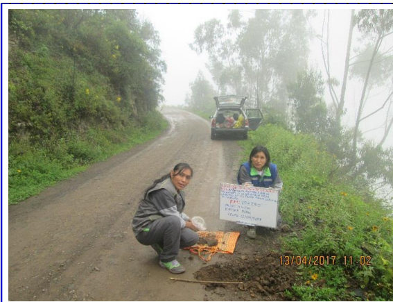
Km 10+250 : ancho de la via = 3.40 m, espesor de afirmado 0.09m
