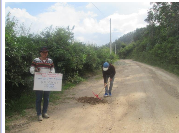
Km 3+750 : ancho de la via = 4.40 m, espesor de afirmado 0.32m
