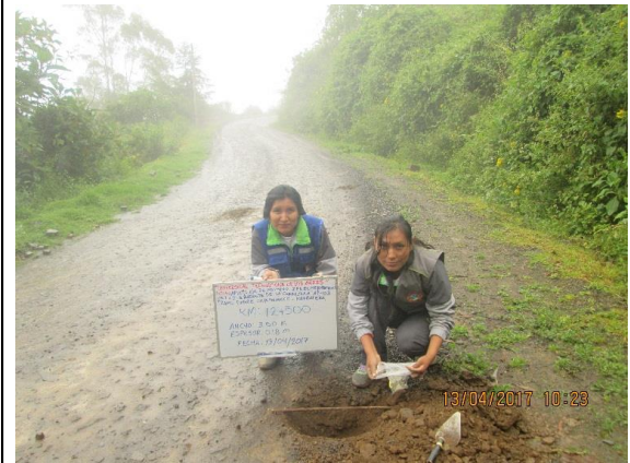
Km12+000 : ancho de la via = 3.10 m, espesor de afirmado 0.18m
