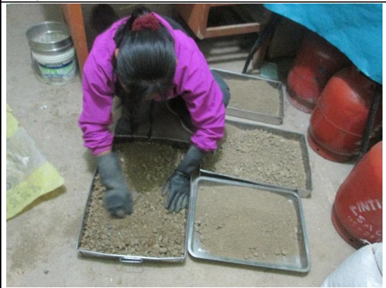
Mescla de suelo con 2% de contenido de agua, posterior a 4%, 6% y 8%.
