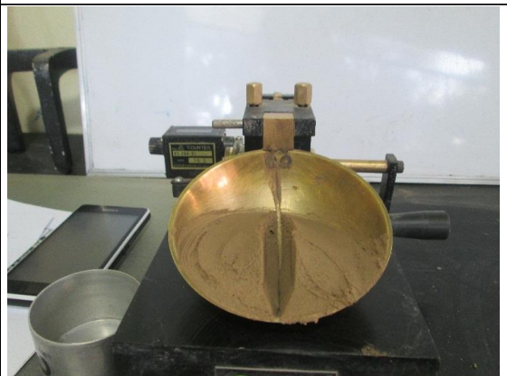
Cuchara de casagrande con muestra que cerro en 18 golpes.
