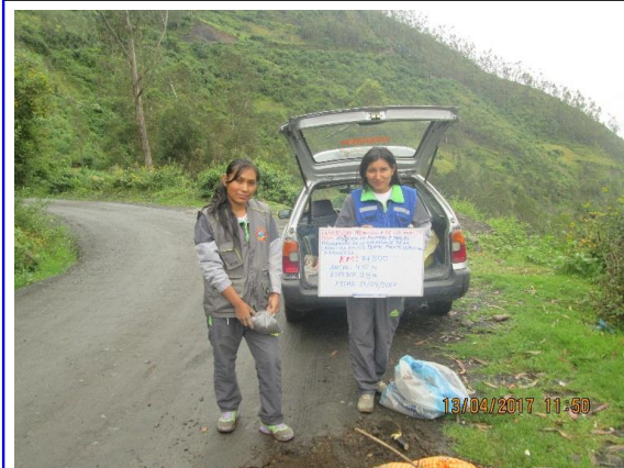
Km 7+000 : ancho de la via = 3.60 m, espesor de afirmado 0.11m
