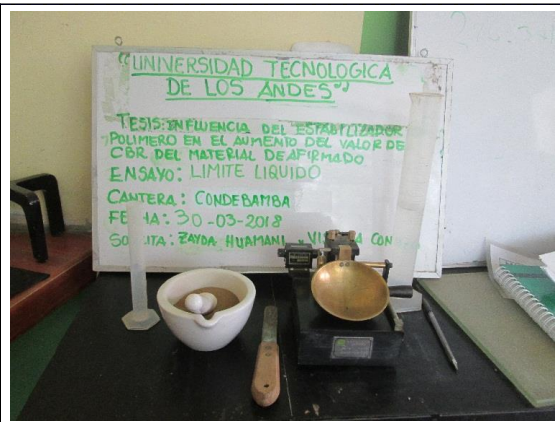
Equipos y herramientas para realizar ensayo de limite liquido de suelo natural
