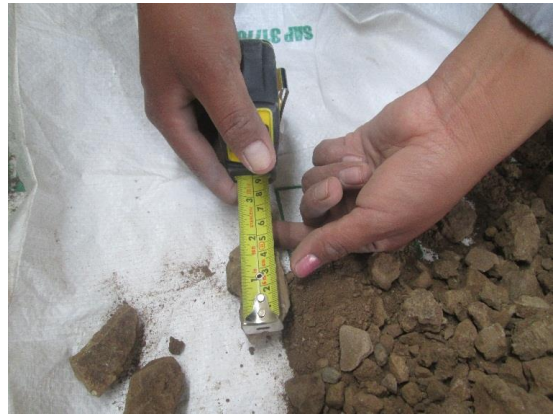
Calculando el tamaño nominal maximo del suelo para determinar la cantidad de muestra para granulometria.
