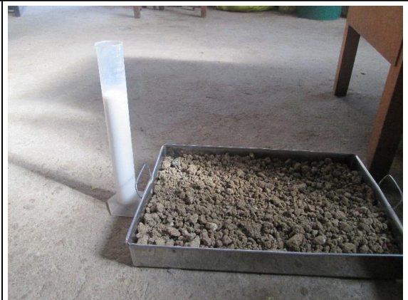
Tesista realizando limite liquido de suelo aplicando polímero.
