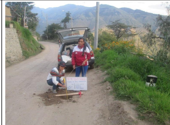
Km 1+500 : ancho de la vía = 3.90 m, espesor de afirmado 0.21m
