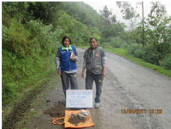
Km 11+750 : ancho de la via = 3.00 m, espesor de afirmado 0.16 m
