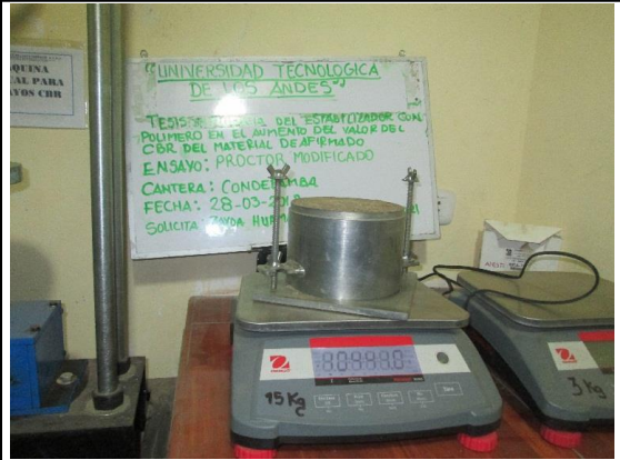
Pesado de molde con muestra compactada para determinar la densidad del suelo.
