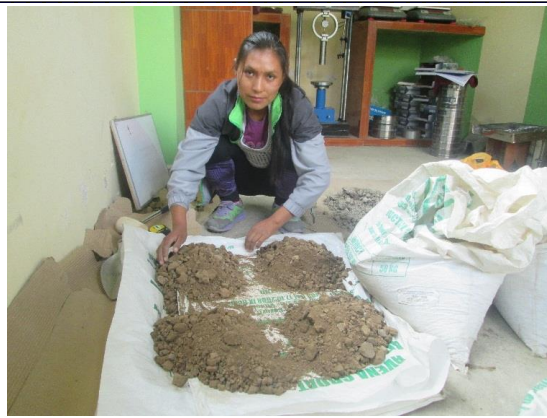
Cuarteo de muestra para realizar ensayo granulometrico
