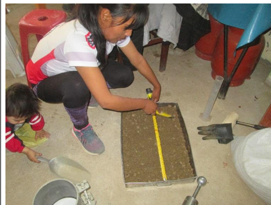
Dividiendo muestras en 5 partes iguales para realizar el proctor modificado.
