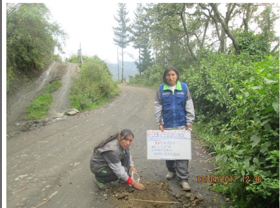
Km 5+750 : ancho de la vía = 3.80 m, espesor de afirmado 0.11m
