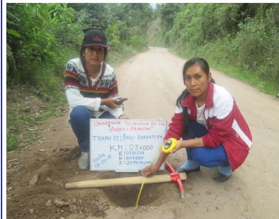
Km 2+500 : ancho de la via = 4.50 m, espesor de afirmado 0.27m
