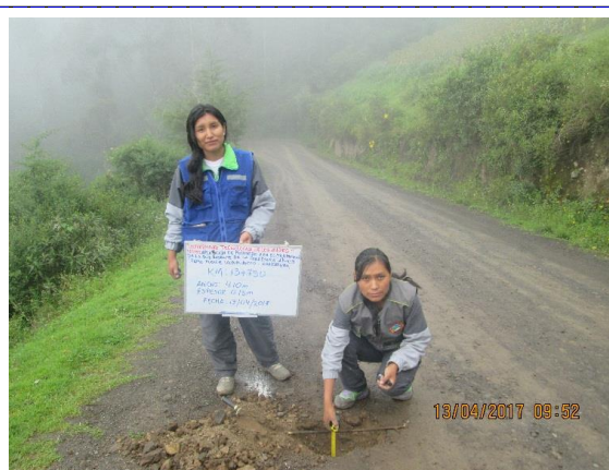
Km13+750 : ancho de la via = 4.00 m, espesor de afirmado 0.14 m
