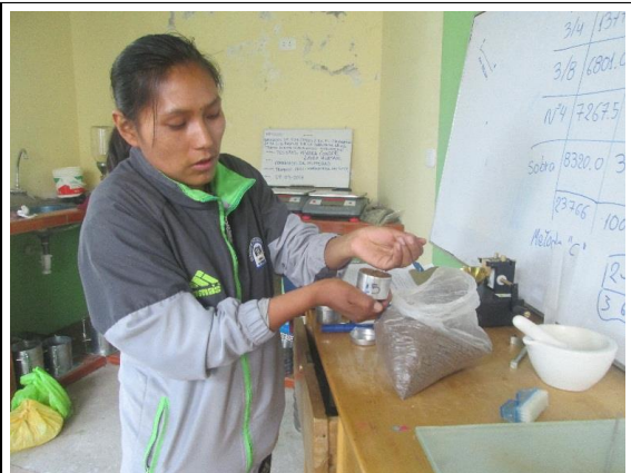
Colocacion de muestra en tara para realizar ensayo de contenido de humedad en suelos alterados.
