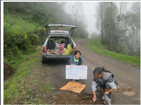
Km 9+250 : ancho de la via = 3.70 m, espesor de afirmado 0.19 m
