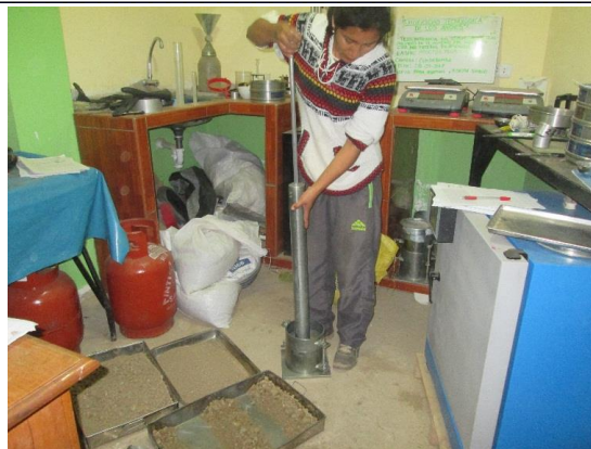
Compactacion de suelo cada 5 capas a 56 golpes cada una con pison manual.
