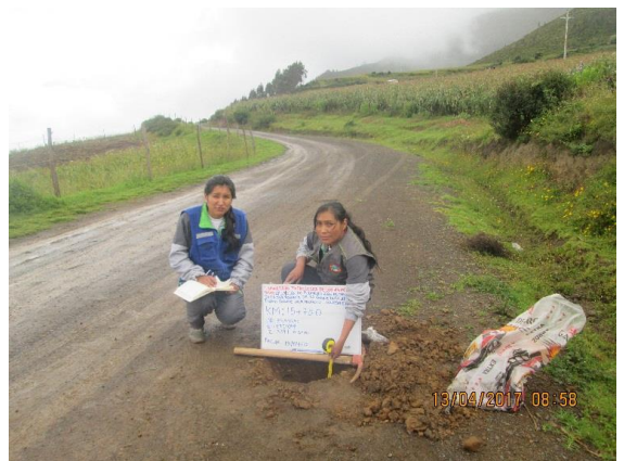
Km15+750 : ancho de la via = 3.80 m, espesor de afirmado 0.10m
