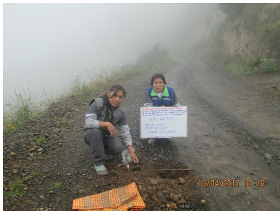
Km 12+250 : ancho de la via = 3.60 m, espesor de afirmado 0.09 m
