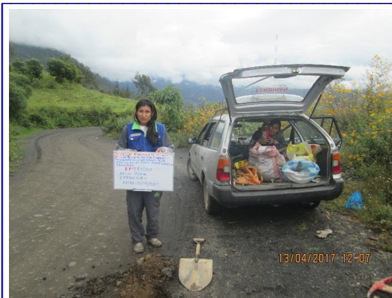
Km 6+500 : ancho de la via = 4.40 m, espesor de afirmado 0.32m
