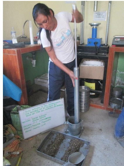
Compaction de suelo cada 5 capas a 56 golpes cada una con pison manual.
