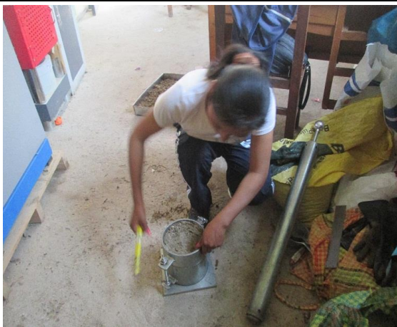
Tesista quitando anillo de molde para luego realizar el corte y nivelado.
