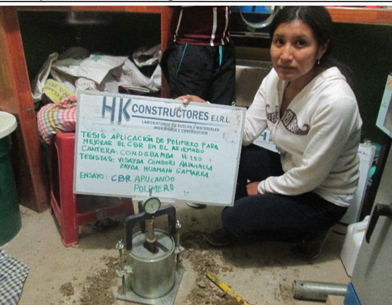
Muestra con dial para lectura de expansión
