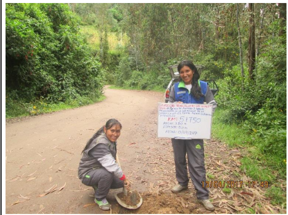
Km 5+250 : ancho de la vía = 3.80 m, espesor de afirmado 0.21m
