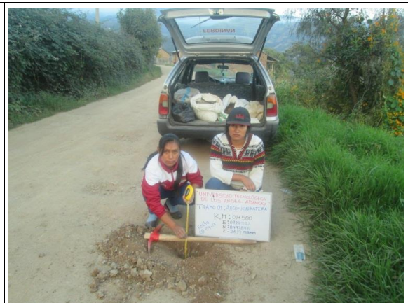
Km 1+500 : ancho de la vía = 3.90 m, espesor de afirmado 0.21m
