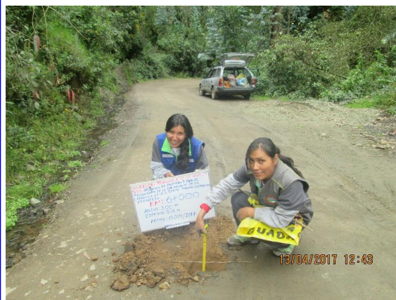
Km 5+500 : ancho de la vía = 3.90 m, espesor de afirmado 0.24m
