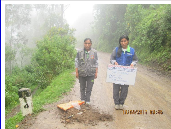
Km 13+250 : ancho de la via = 3.50 m, espesor de afirmado 0.12m
