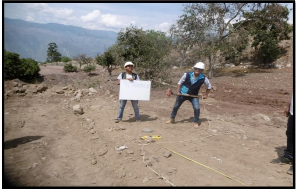
Figura N°4.18: Uso de comba para determinar la vibración del suelo.
