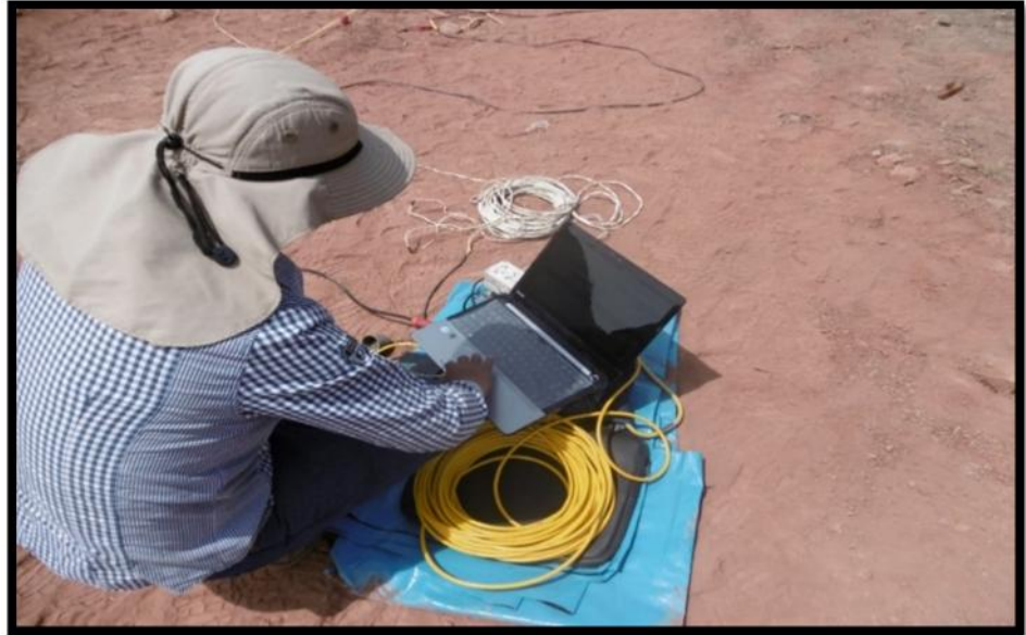
Figura N°4.15: Instalación de equipo para lectura de ondas.
