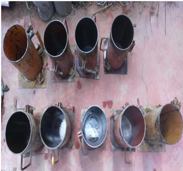
Moldes limpios y pasados con petróleo listo para proceder al moldeo
