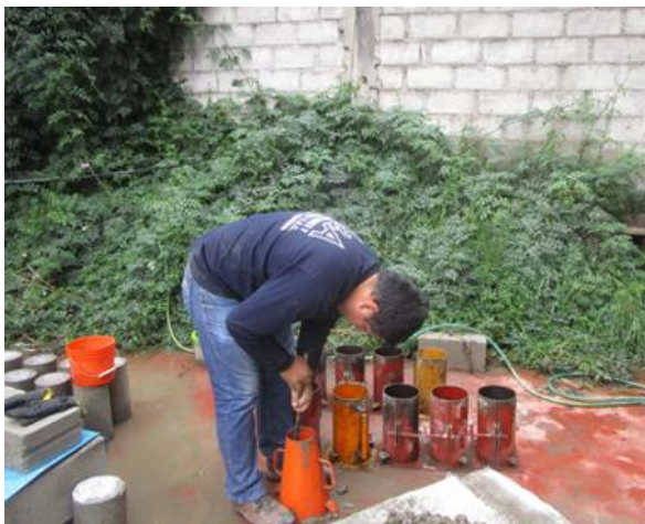
ensayo del cono de Abrams ( revenimiento)
