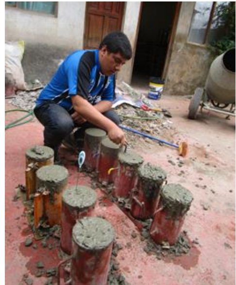
Imagen mostrando el acabado que se les da a cada una de las briquetas
