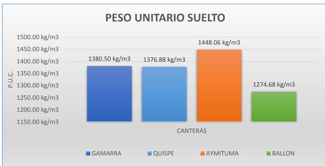
Imagen 14: Comparativo entre pesos específicos suelto agregado grueso
