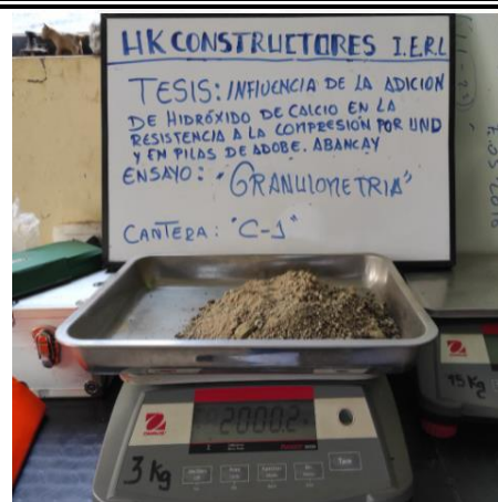
Figura 31: pesado de cada cantidad retenida luego del tamizaje.
