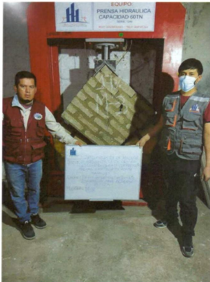
Imagen 09: toma de datos del tipo de falla, el comportamiento que manifiesta el muro en el proceso de compresión.
