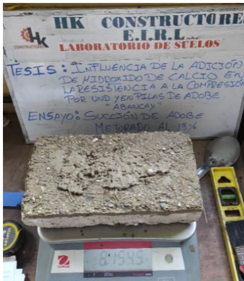
Figura 44: pesado de la muestra, luego de la succión.
