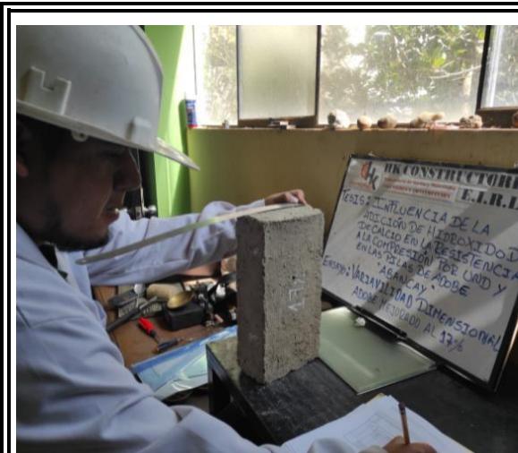
Figura 40: Toma de medidas en las demás dimensiones.
