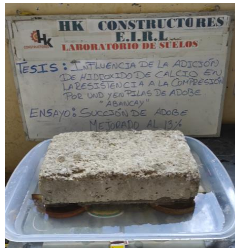
Figura 43: colocación de agua en el recipiente hasta la altura indicada.
