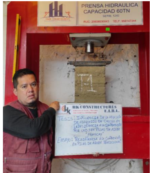
Figura 51: Colocación de las pilas de adobe en la máquina compresora.
