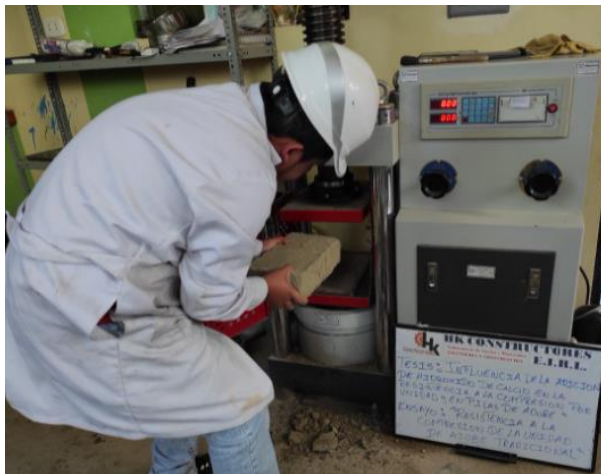
Figura 46: colocación de la unidad de adobe en la máquina de compresión.
