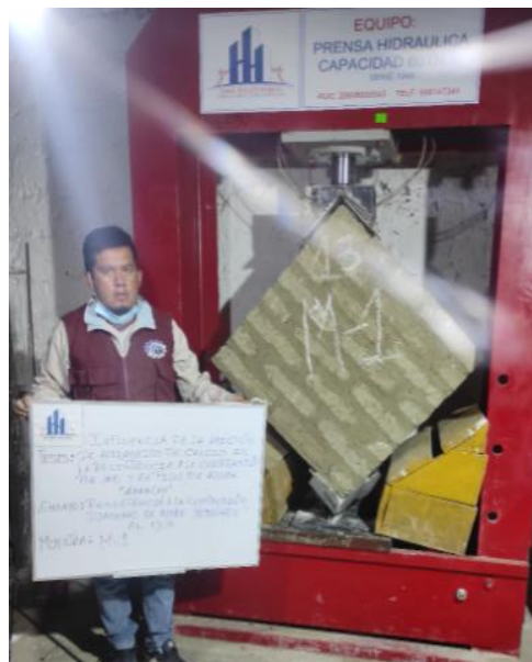
Figura 55: Colocación del muro de adobe en a máquina compresora.
