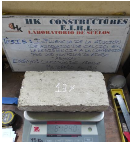
Figura 42: pesado de la unidad de adobe en la balanza electrónica.
