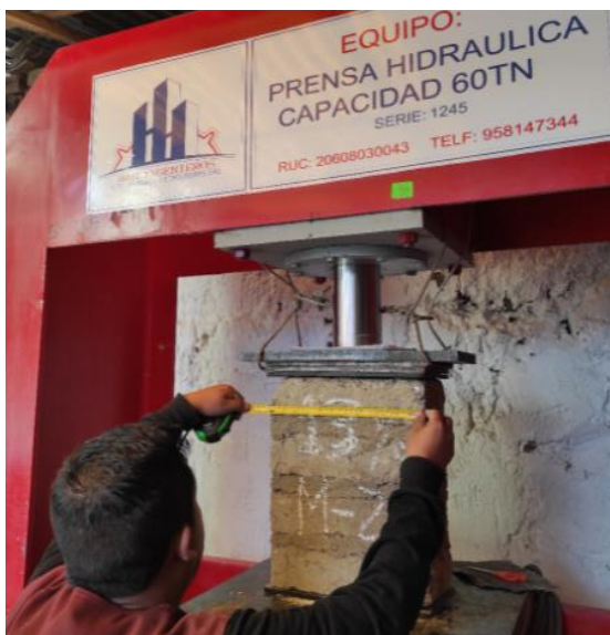
Figura 52: Toma de medidas de la pila de adobe antes de ser sometida a cargas.
