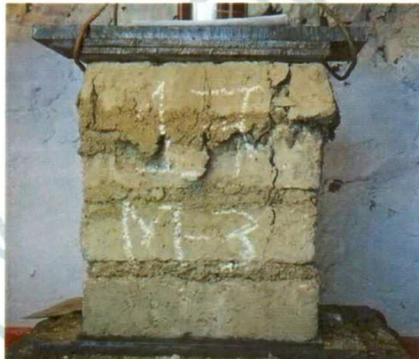
Imagen 04: muestra el tipo de falla luego de resistir la carga máxima, aplastamiento de las unidades, descascaramiento de las paredes de la unidad y los cortes verticales.
