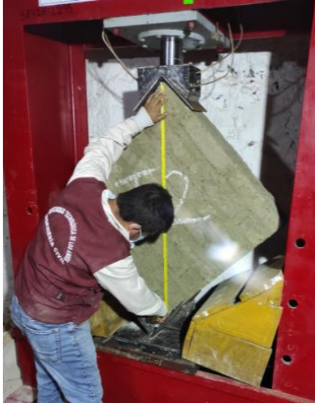
Figura 56: Toma de medidas del muro antes de ser sometido a carga.
