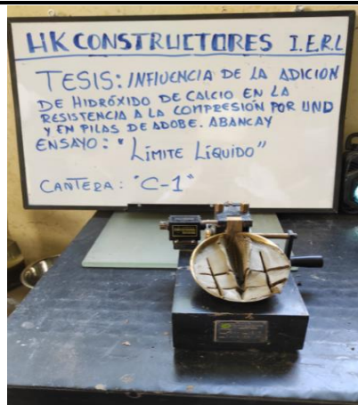
Figura 24: inicio de golpeo, para cerrar la ranura generada.
