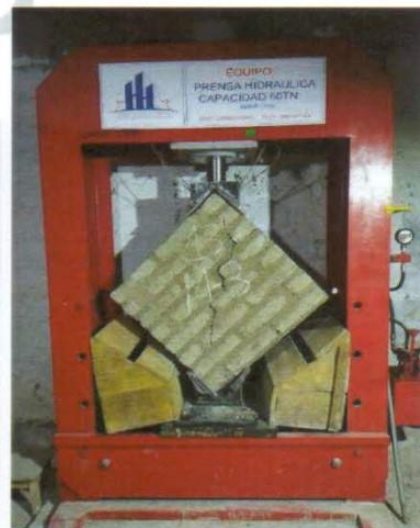
Imagen 08: muestra el tipo de falla que tiene el muro, se ve una falla mixta inicia con fallas en las juntas escalonadamente y luego diagonalmente.
