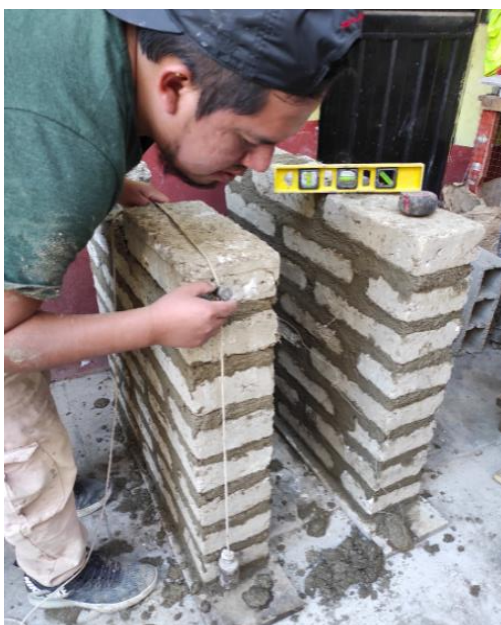
Figura 54: Elaboración de los muros de adobe para el ensayo.
