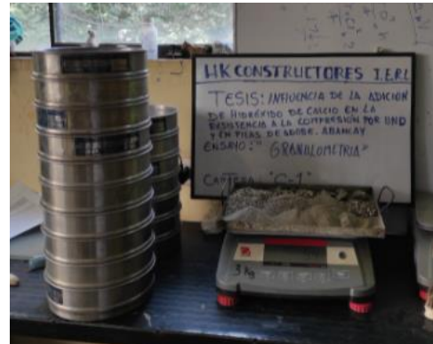
Figura 33: obtención de los pesos, para la realización de la curva granulométrica.
