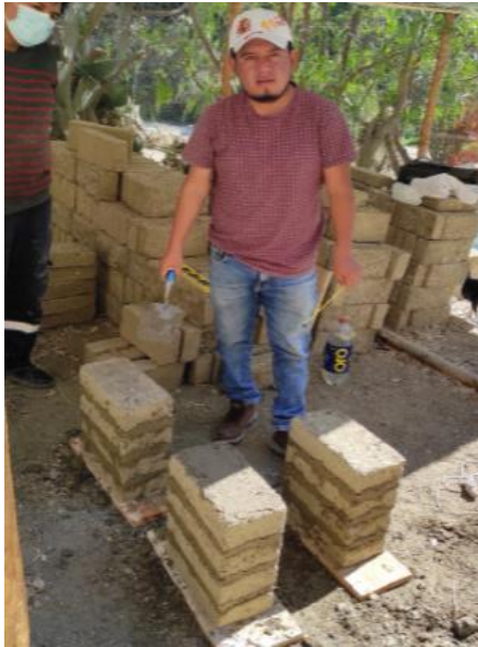
Figura 50: Elaboración de pilas de adobe.
