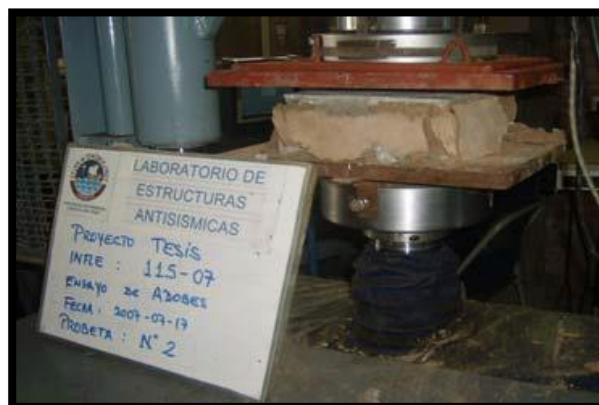
Figura 19. Ensayo de resistencia a la compresión.
