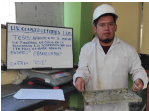
Figura 32: obtención de grupos de acuerdo a gradación de tamaño de partículas.
