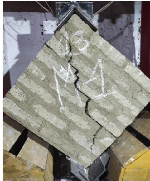
Figura 57: El muro de adobe ha sido sometido a cargas hasta el fallo total.
