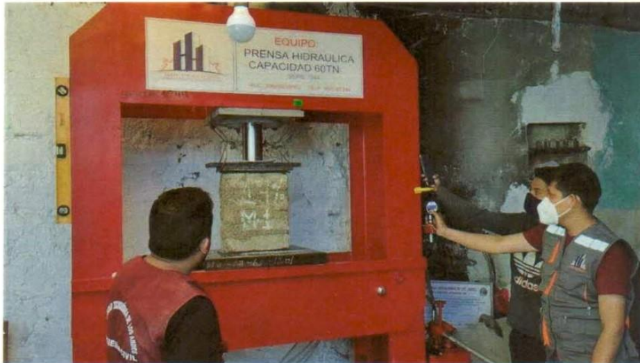
Imagen 03: Proceso de compresión de muestra y toma de datos del comportamiento.
