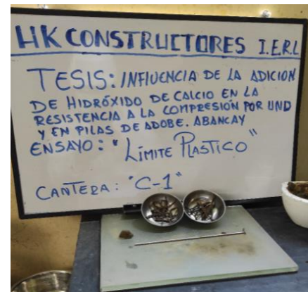
Figura 27: obtención de tiras de aprox. 3mm de diámetro.
