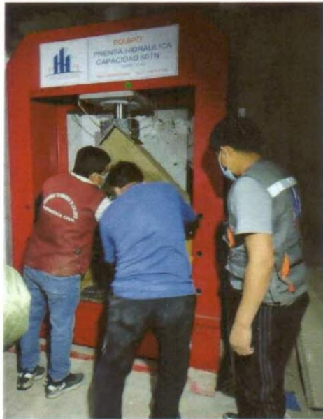
Imagen 05: muestra el proceso de colocación de los muros de adobe al equipo.
