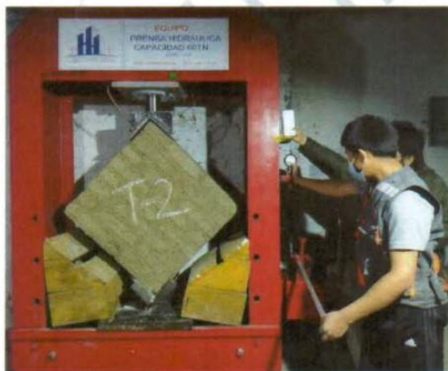
Imagen 07: Proceso de sometimiento a carga diagonal al muro.
