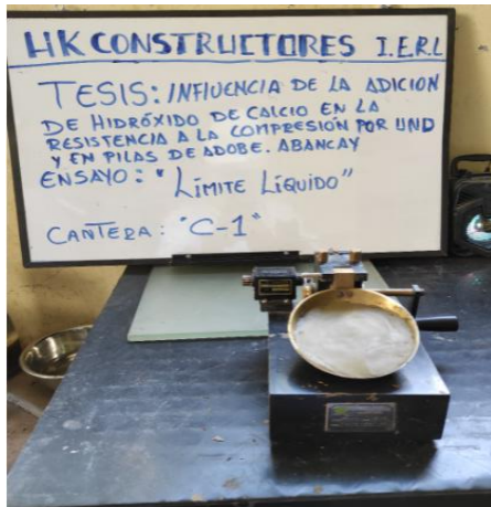
Figura 22: colocación de muestra en la cuchara casa grande.
