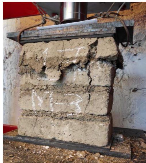
Figura 53: La pila de adobe ha sufrido el fallo total.
