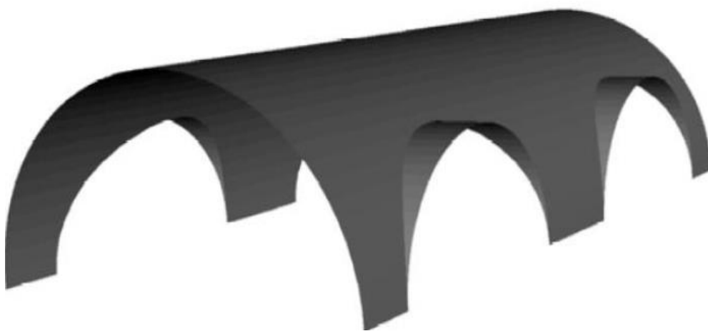
figura 4. Bóveda de lunas en sus formas de transmitir cargas.
