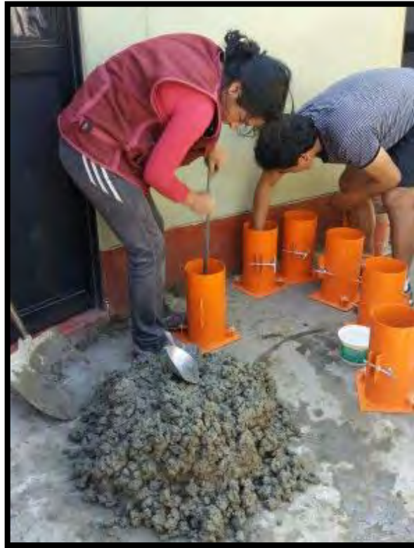
Ilustración 4-49 Colocación de concreto en probetas.
