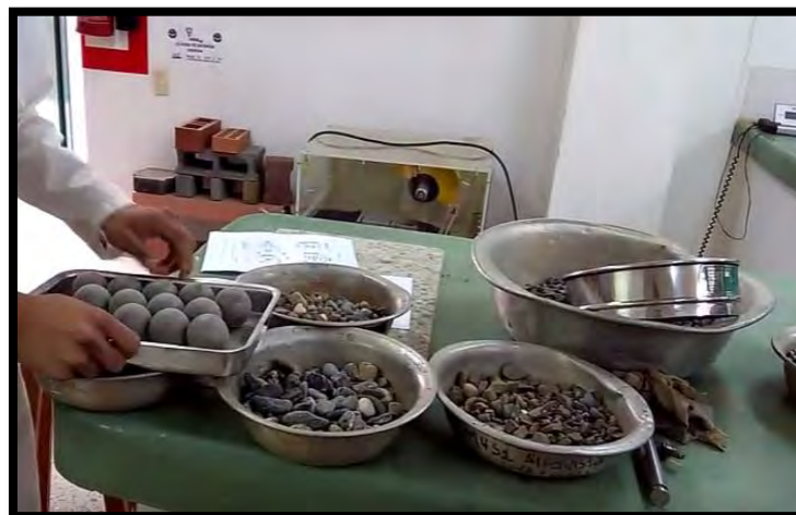
Ilustración 4-32 Tamizado del material grueso para el ensayo de abrasión
