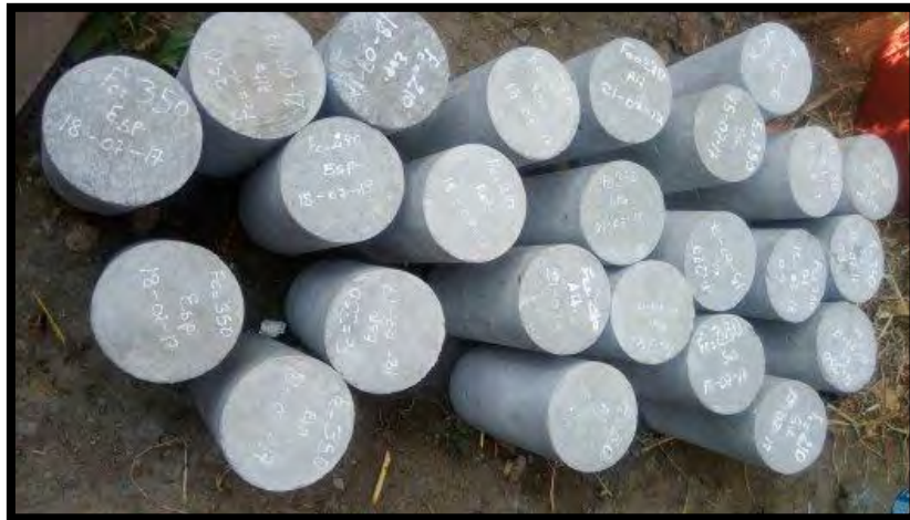
Ilustración 4-56 Probetas de Concreto Listas Para El Ensayo de Compresión – Curado Insitu
