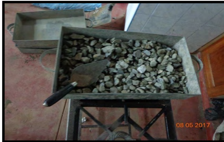
Ilustración 4-30 Secado del material grueso a temperatura constante
