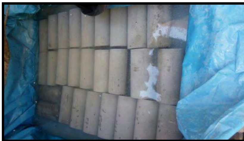
Ilustración 4-53 Curado de probetas de concreto – Método sumergido en agua
