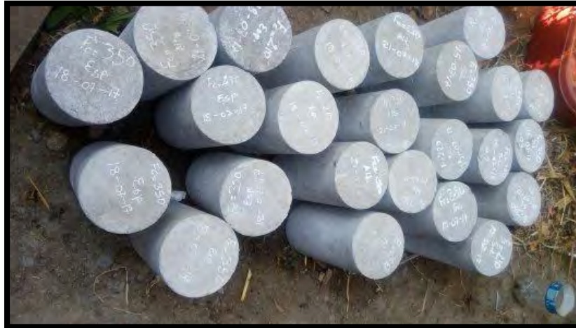
Ilustración 4-54 Curado de Probeta de Concreto – Método Insitu
