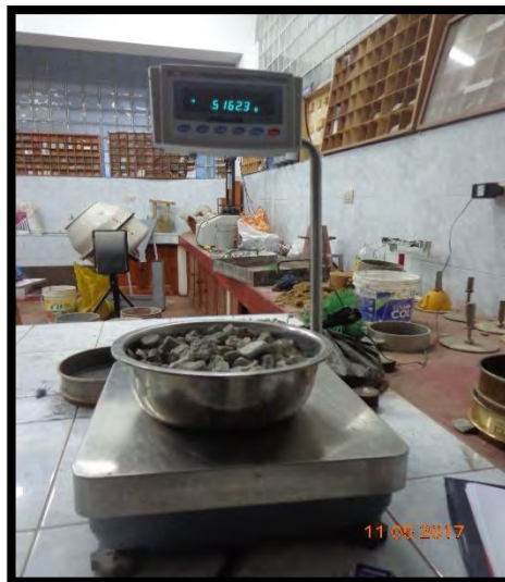
Ilustración 4-37 Toma de datos del material grueso
