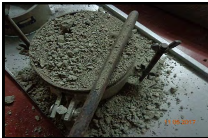
Ilustración 4-18 Enrase del material excedente
