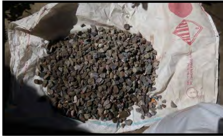
Ilustración 4-43 Agregado grueso a utilizar en la elaboración del concreto
