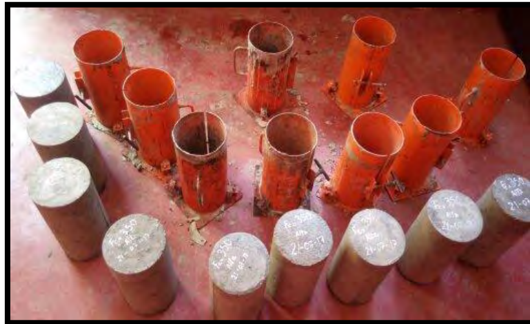
Ilustración 4-51 Desencofrado de probetas de concreto
