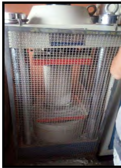
Ilustración 4-57 Ensayo de Compresión de Probetas de Concreto
