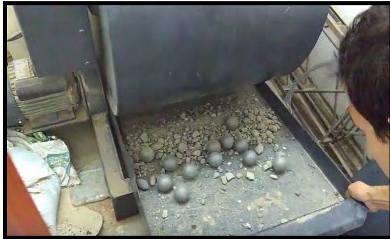
Ilustración 4-34 Retiro del material grueso una vez terminada el ensayo
