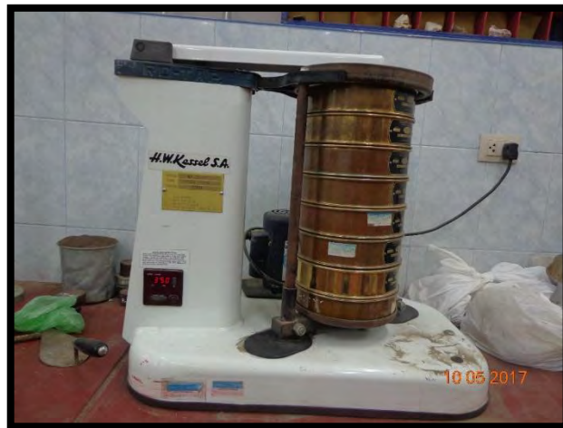
Ilustración 4-24 Tamizando el material grueso
