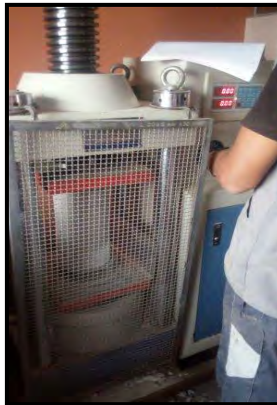
Ilustración 4-55 Ensayo de Compresión De Probetas De Concreto
