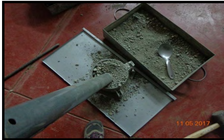
Ilustración 4-19 Peso volumétrico compacto del material fino
