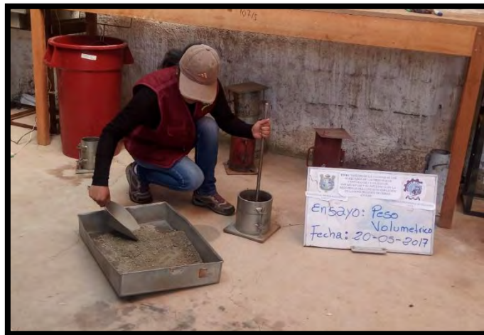
Ilustración 4-16 Peso volumétrico suelto del material fino
