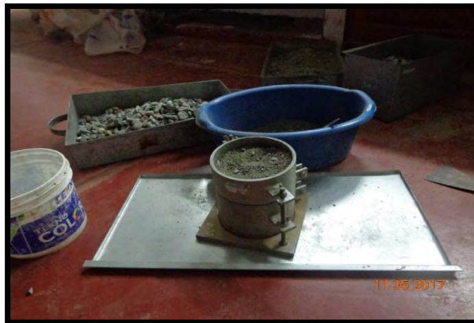
Ilustración 4-17 Compactación del material fino
