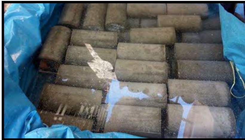
Ilustración 4-52 Curado de Probetas de Concreto – Método Sumergido de Agua
