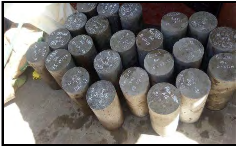
Ilustración 4-58 Probetas de Concreto Listas para el Ensayo de Compresión – Curado Sumergido
