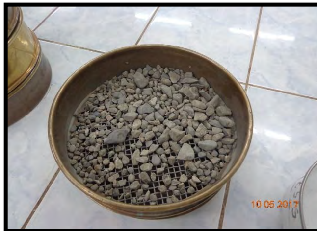
Ilustración 4-25 Material retenido en el tamiz n° 16
