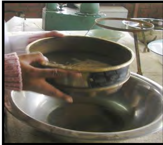
Ilustración 4-14 Material Retenido en la Malla N° 200
