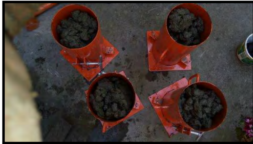
Ilustración 4-47 Elaboración de testigos de concreto
