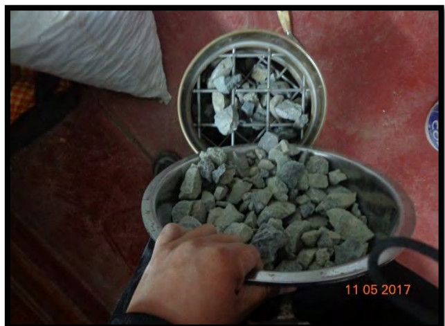
Ilustración 4-22 Secado del material – temperatura constante
