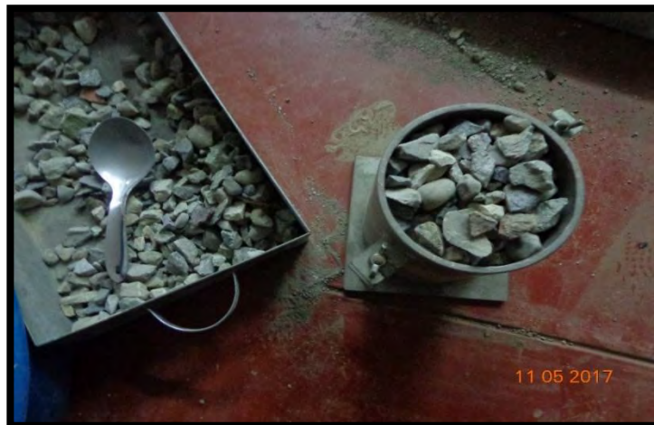
Ilustración 4-20 Peso volumétrico compacto, material grueso
