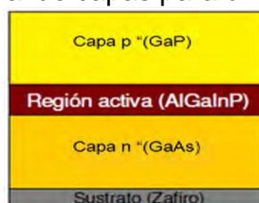
FIGURA. N° 01: Estructura general de capas para un LEDs de potencia.
