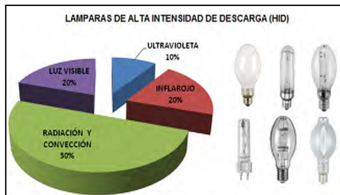
FIGURA N° 03. Porcentaje de radiaciones emitidas por las lámparas de alta intensidad de descarga.
