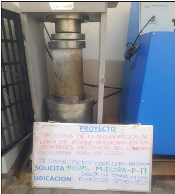
Rotura de las probetas cilíndricas y vigas de concreto con sustitución parcial del cemento por ceniza de Agave Americano
