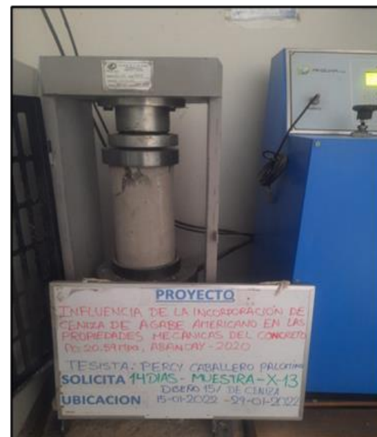
Rotura de las probetas de concreto con sustitución parcial del cemento por ceniza de Agave Americano
