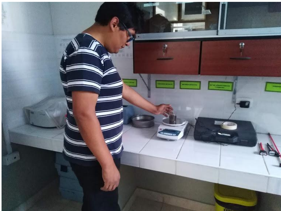
Fotografía N° 04. Pesado de muestra de abono para el cálculo de proporciones de cada tratamiento.
