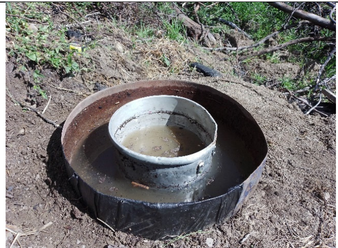
Infiltración del agua mediante los anillos de infiltración - Prueba infiltrómetros doble anillo
