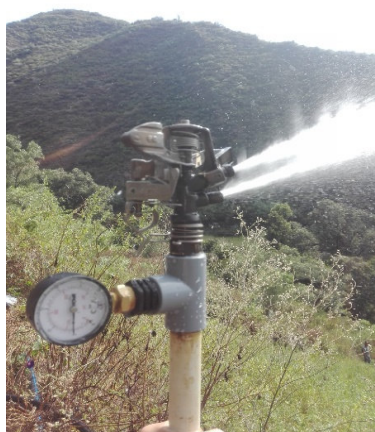
Medición de presión de aspersores – Prueba de pluviometría
