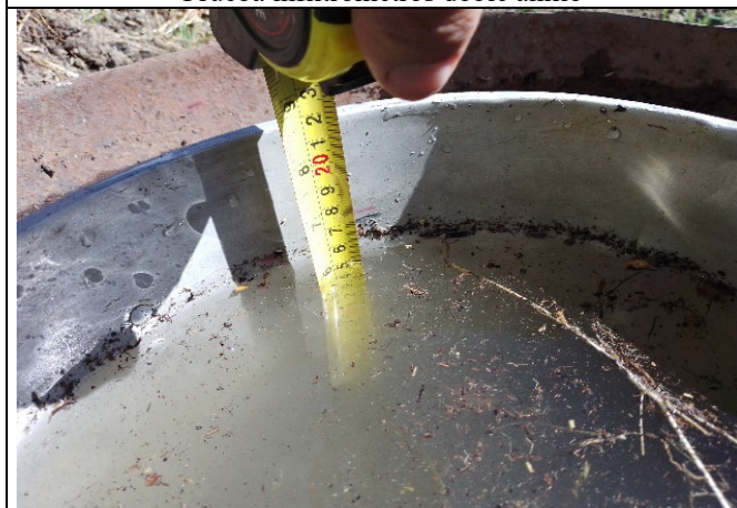
Medición del nivel de agua Infiltrada - Prueba infiltrómetros doble anillo
