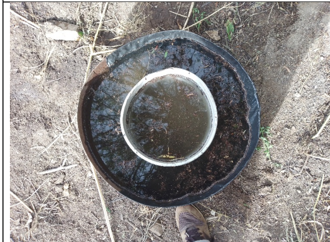
Llenado de agua de los anillos de infiltración - Prueba infiltrómetros doble anillo
