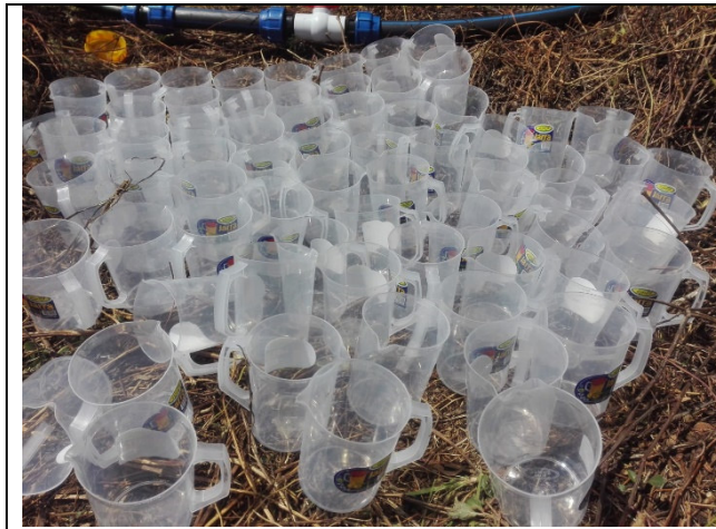
Pluviómetros en campo – Prueba de pluviometría
