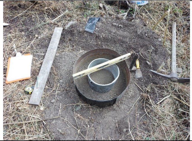
Colocado y nivelación de los anillos - Prueba infiltrómetros doble anillo
