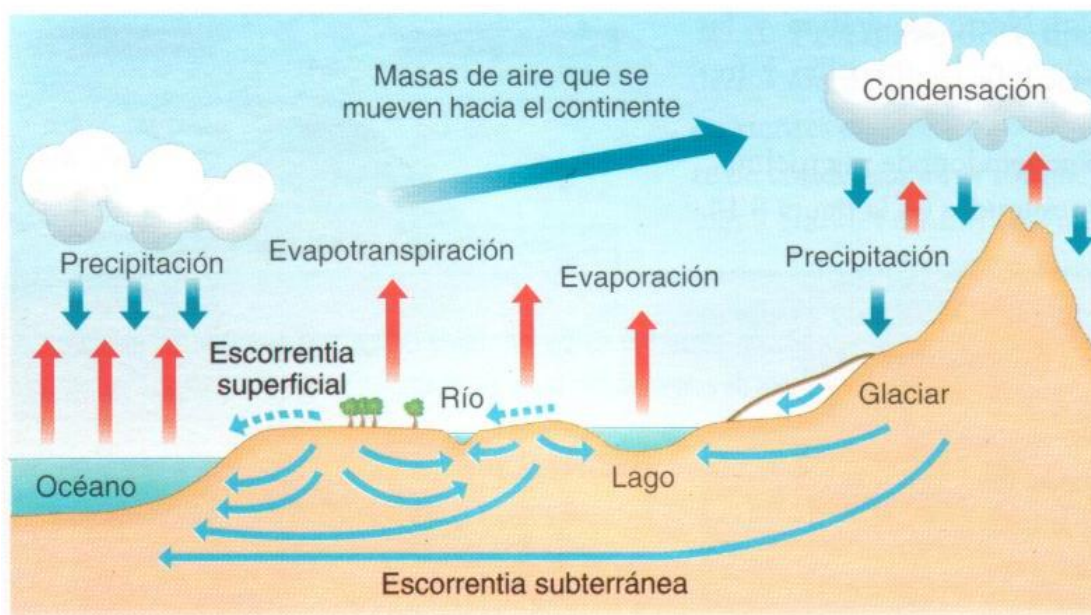
Figura 3. Representación del Ciclo Hidrológico Fuente: Musy, André, 2001. Cours "Hydrologie générale" . Ecole Polytechnique Fédérale de Lausanne. IATE/HYDRAM. Laboratoire d'Hydrologie et Aménagement. Capítulo 1. El ciclo hidrológico
