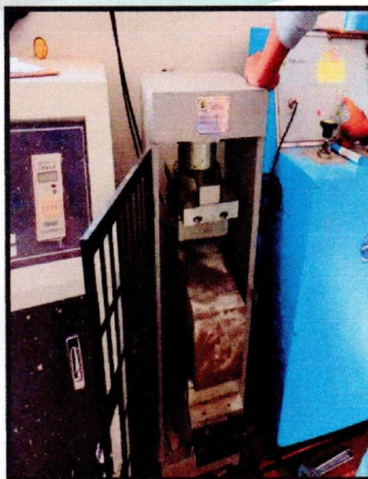
Imagen 10 ensayo de resistencia a la flexión de vigas en laboratorio
