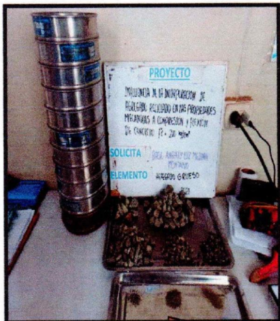
Imagen 01 Ensayo de Análisis Granulométrico
