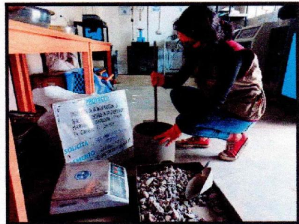
Imagen 04 Ensayo de peso unitario suelto y compactado de agregado grueso
