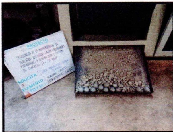
Imagen 03 Ensayo de abrasión en agregado grueso
