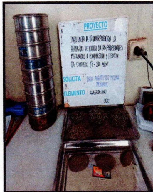
Imagen 02 Ensayo de Análisis Granulométrico de agregado fino
