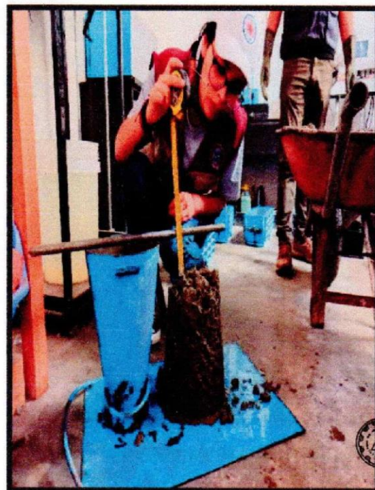
Imagen 08 Ensayo de peso unitario suelto y compactado de agregado grueso
