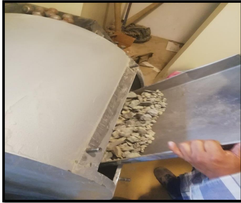
Figura 28. Colocado de la muestra a la máquina de Los Ángeles. Fuente: Autoría propia.
