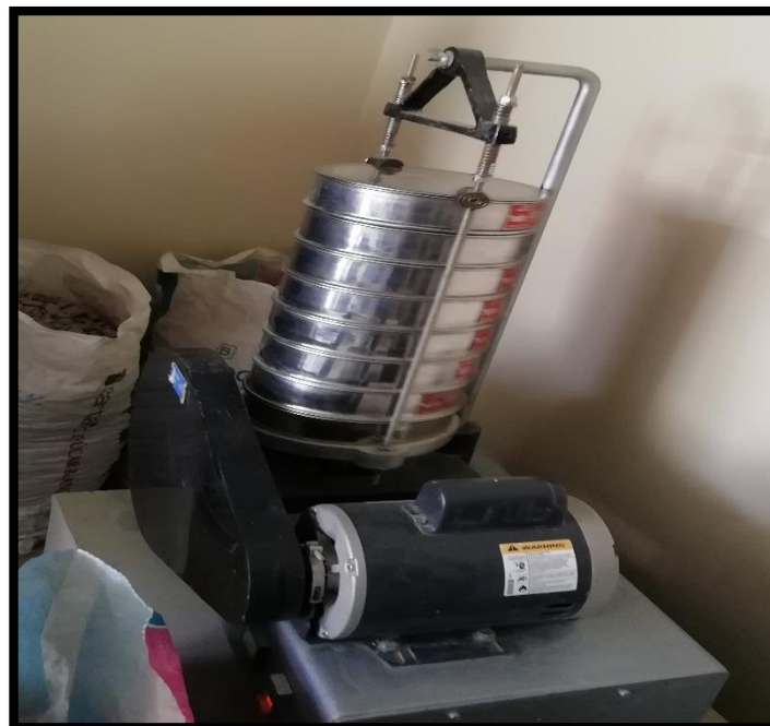
Figura 24. Colocado de los tamices en el agitador mecánico. Fuente: Autoría propia.
