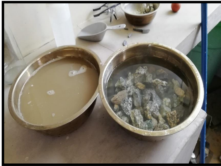
Figura 25. Agregado para determinar el peso específico del agregado grueso. Fuente: Autoría propia.
