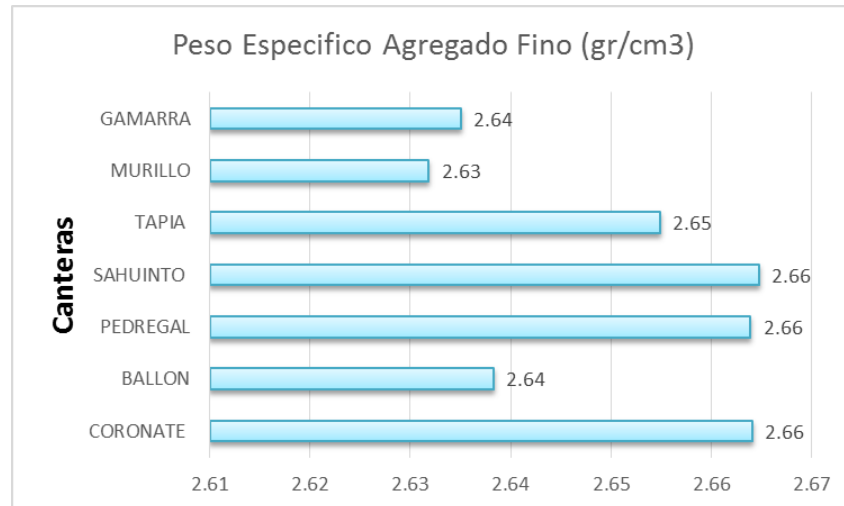
Figura 38: Peso Específico del agregado fino de las 7 canteras.
