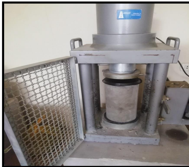
Figura 33. Colocado de la briqueta en las máquinas para la compresión. Fuente: Autoría propia.
