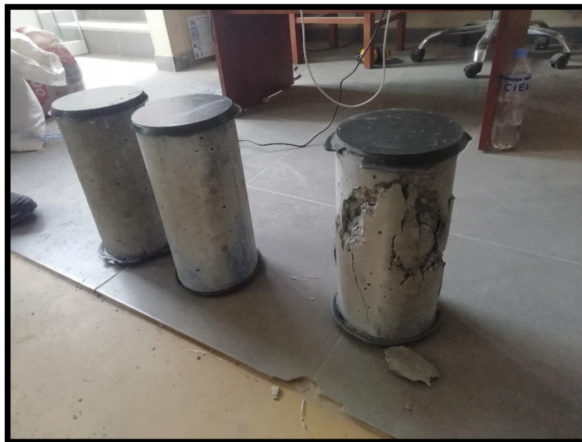
Figura 34. Rotura de briqueta. Fuente: Autoría propia.
