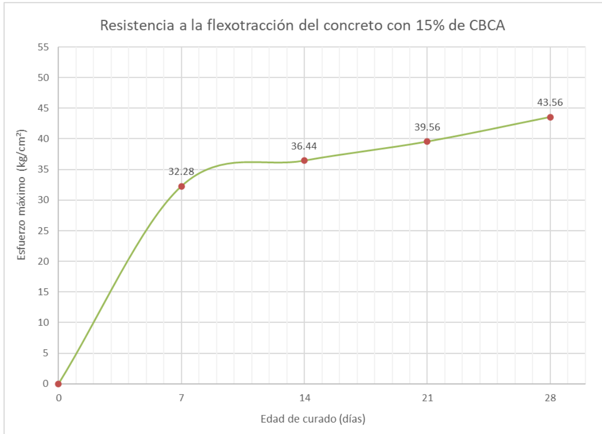
Evolución de la resistencia a la flexotracción del concreto con 15% de CBCA
