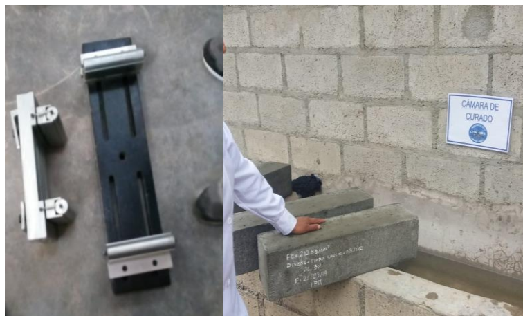
Figura 61 Extracción de los especímenes prismáticos y dispositivo para ensayo a flexión. Fuente: Elaboración propia.
