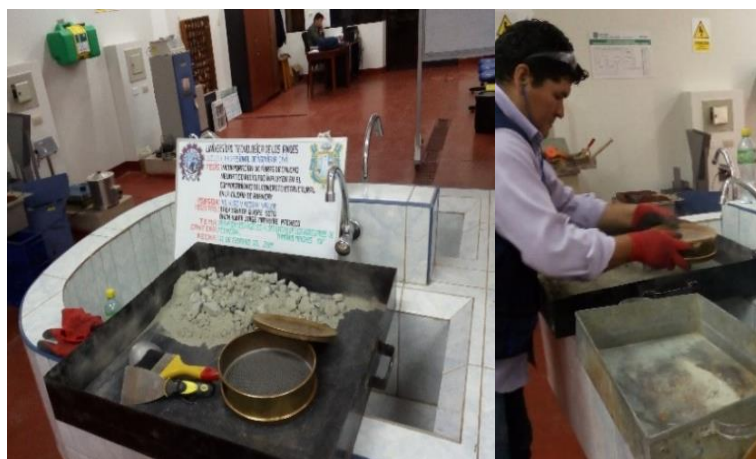
Figura 26 Tamizado de la muestra del desgaste a la abrasión con la malla N° 12. Fuente: Elaboración propia.
