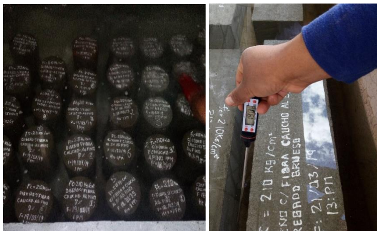
Figura 49 Curado de especímenes y toma de temperatura de los testigos. Fuente: Elaboración propia.
