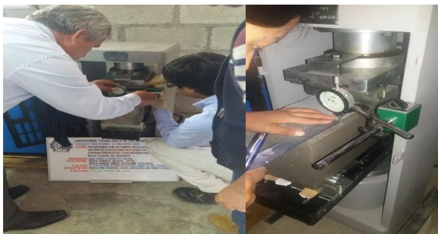
Figura 62 Colocación del dial para la deflexión de la viga, Fuente: Elaboración propia.
