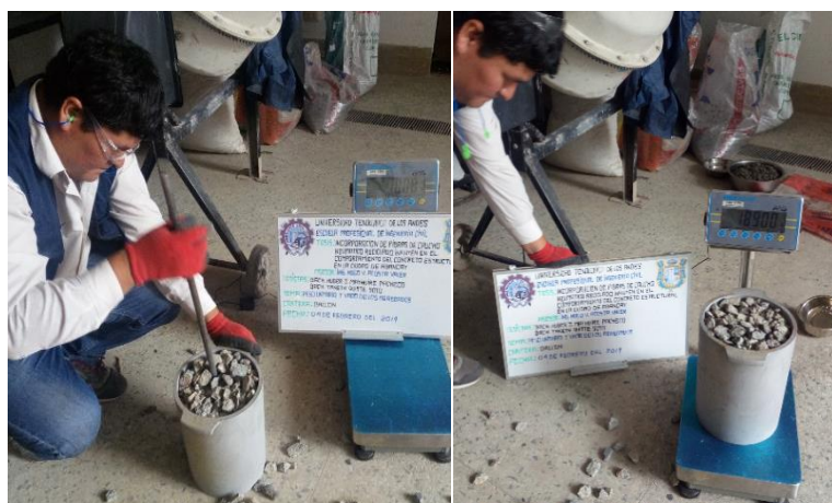
Figura 24 Obtención del peso unitario compactado de la c. Ballón. Fuente: Elaboración propia.
