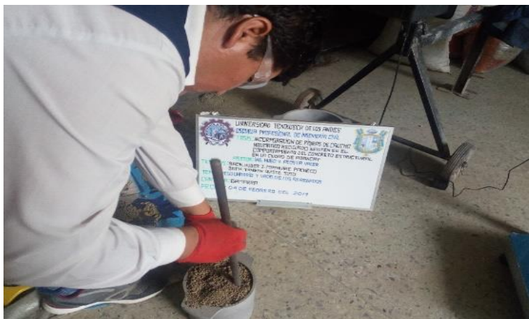
Figura 36 Ensayo del peso unitario compactado del agregado fino. Fuente: Elaboración propia.
