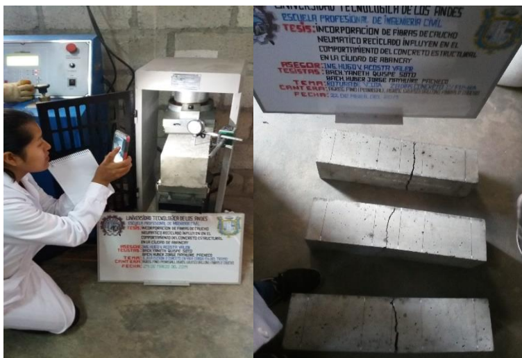
Figura 63 Toma de medida del dial y fallas de la viga.
