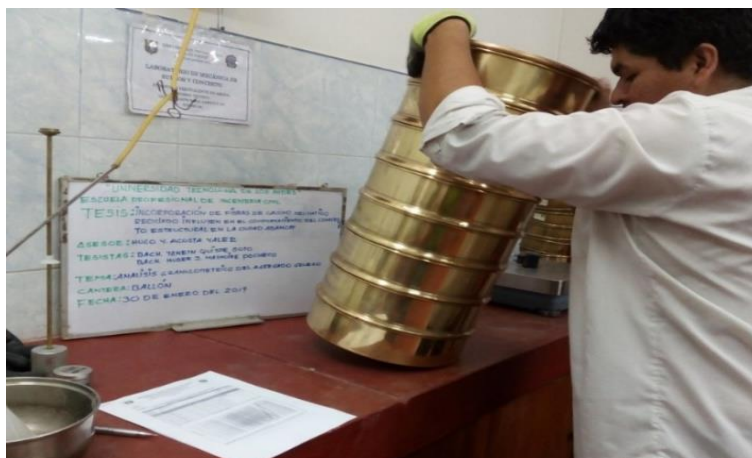
Figura 16 Tamizado manual del agregado grueso de la C. Ballón. Fuente: elaboración propia.
