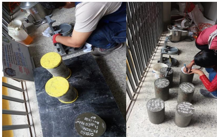
Figura 50 Recubrimiento de superficie del espécimen de apoyo con Capping. Fuente: Elaboración propia.
