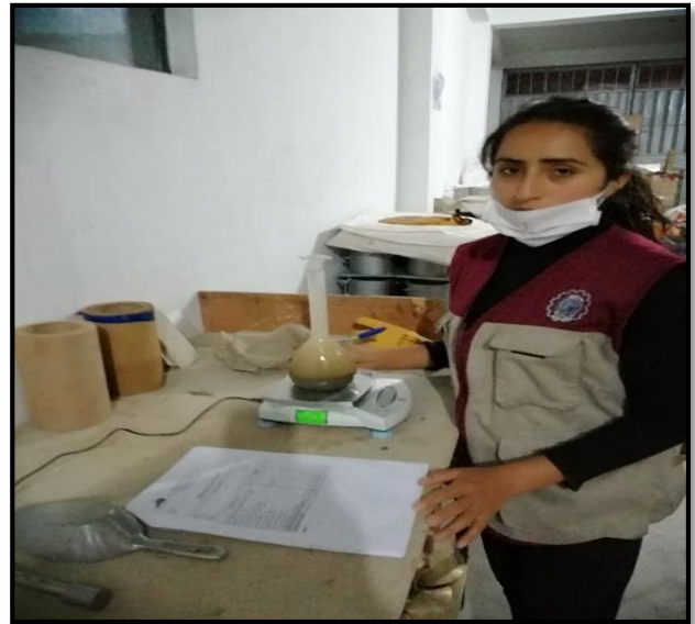
peso de la muestra dentro del picnómetro
