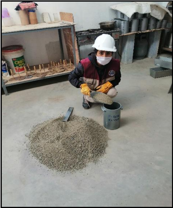
Peso compacto del agregado grueso
