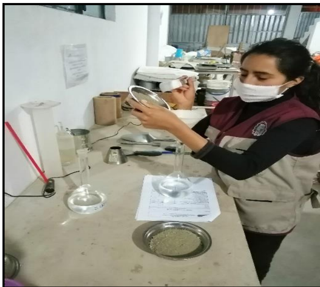
Colocando agua al picnómetro para medir el peso del material
