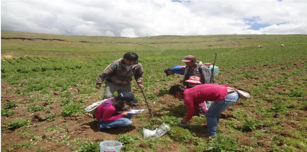
FOTO N° 5: UBICACIÓN, REGISTRO DE DATOS CON GPS Y TOMA DE MUESTRA EN W CON LA AYUDA DEL TUBO AUGER EN LA COMUNIDAD DE CHECCHE.
