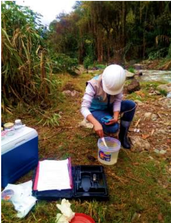
Foto N° 10 y 11 Monitoreo fisicoquímico con multiparametro estación RIMA1
