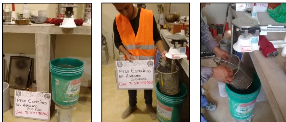
Figura 10. Una recopilación de imágenes del proceso del ensayo de peso específico y el porcentaje de absorción.
