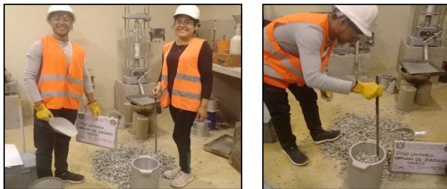
Figura 14. Proceso del ensayo del peso unitario compactado del agregado grueso.
