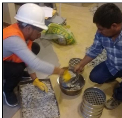
Figura 17. Se aprecia el tamizado de los agregados.
