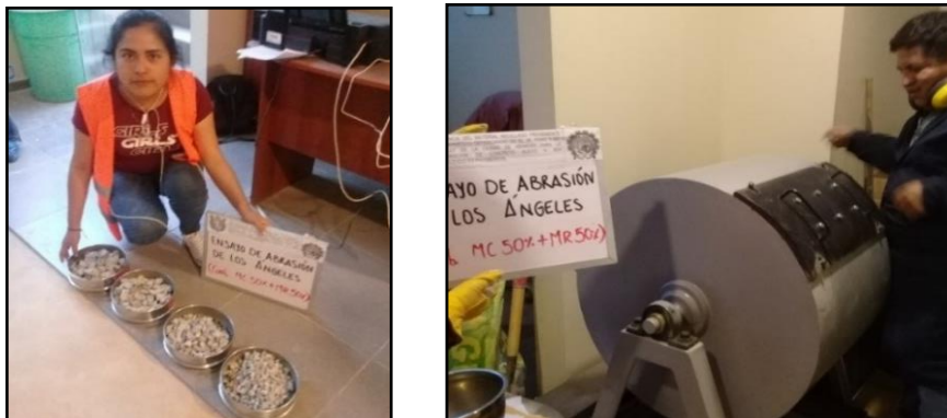
Figura 19. La gradación del agregado grueso para la prueba de desgaste.
