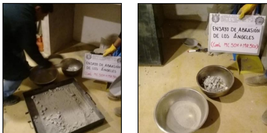
Figura 21. Tamizado del material para abrasión, para determinar el desgaste final.
