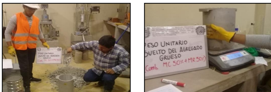
Figura 13. Proceso del ensayo del peso unitario suelto del agregado grueso.
