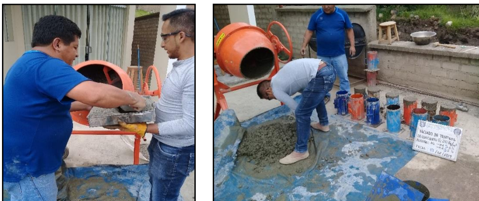
Figura 25. Proceso de elaboración de concreto con 50% MC + 50% MR
