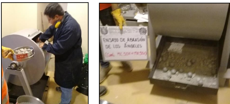
Figura 20. La colocación del material en la máquina de abrasión de los ángeles.
