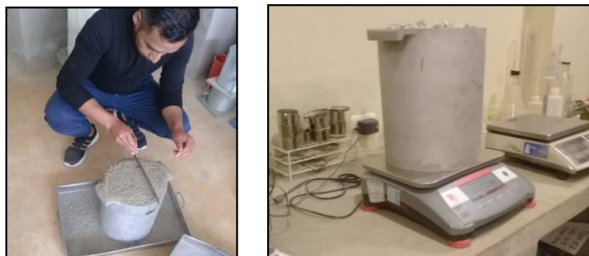
Figura 15. El peso unitario del agregado fino.
