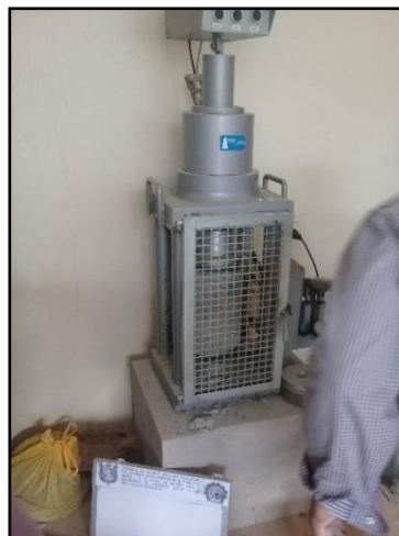
Figura 28. Capeado y rotura de probetas de concreto.
