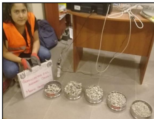
Figura 16. El agregado grueso extendido para la gradación respectiva.
