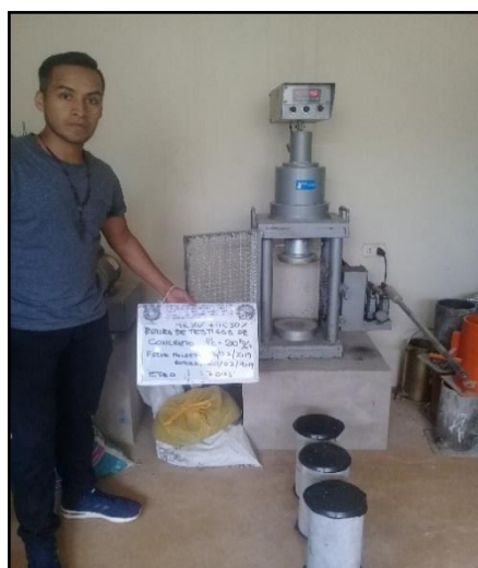
Figura 29. Rotura de briquetas, concreto 50% MC + 50% MR.
