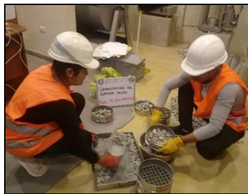
Figura 16. El agregado grueso extendido para la gradación respectiva.
