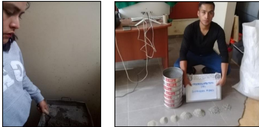
Figura 18. Tamizado del agregado fino.
