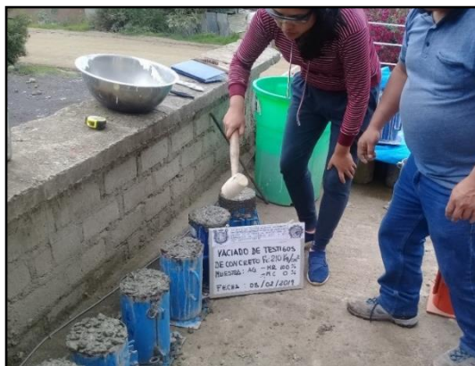
Figura 23. Vibrado manual de briquetas.
