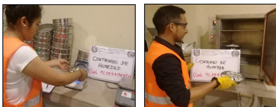
Figura 8. Cont. de humedad del agregado grueso 25% MC + 75% MR.
