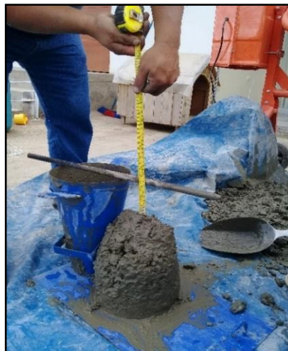
Figura24 .Elaboración de concreto y prueba de cono de Abrams para asegurar el slump.
