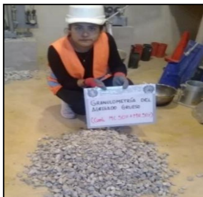
Figura 16. El agregado grueso extendido para la gradación respectiva.
