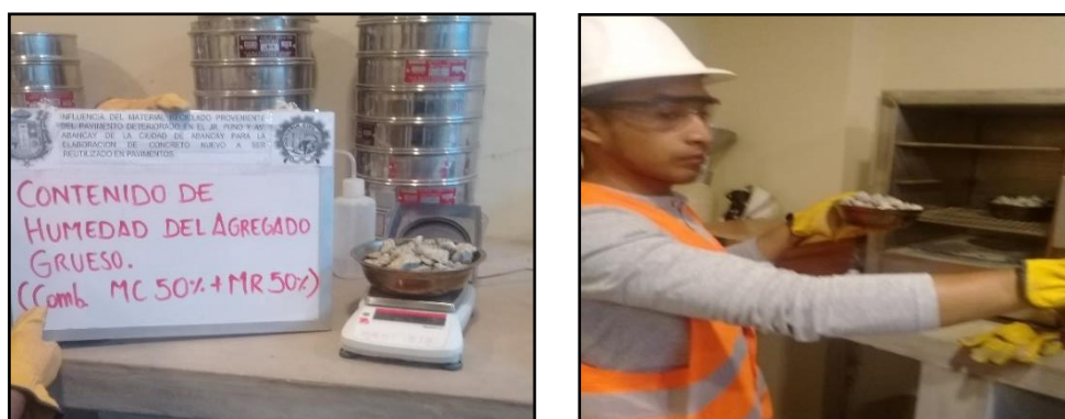
Figura 6. Cont. de humedad del agregado grueso 50% MC + 50% MR
