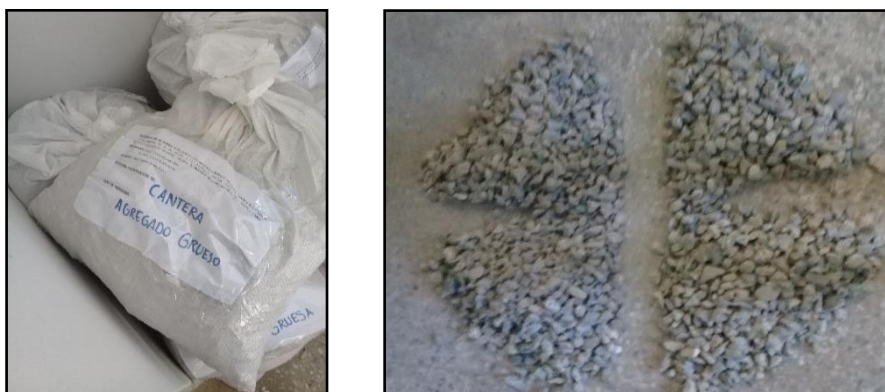
Figura 1. Recolección y etiquetado de muestras de agregado grueso proveniente de cantera
