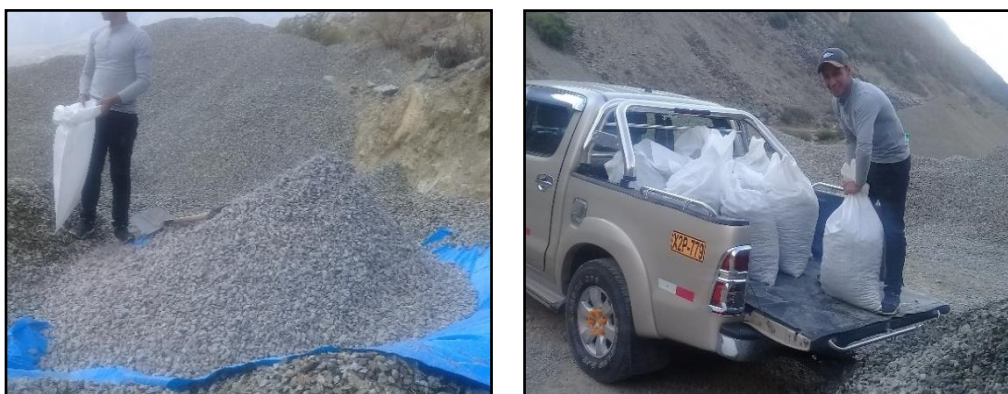
Figura 4. Recolección y etiquetado de muestras de agregado reciclado.
