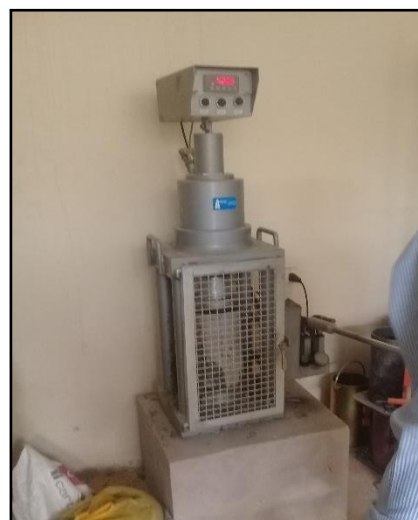
Figura 29. Rotura de briquetas, concreto 50% MC + 50% MR.
