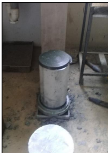
Figura 28. Capeado y rotura de probetas de concreto.
