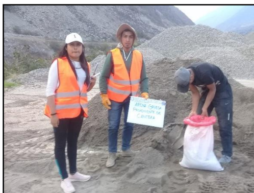
Figura 5. Recolección y etiquetado de agregado fino
