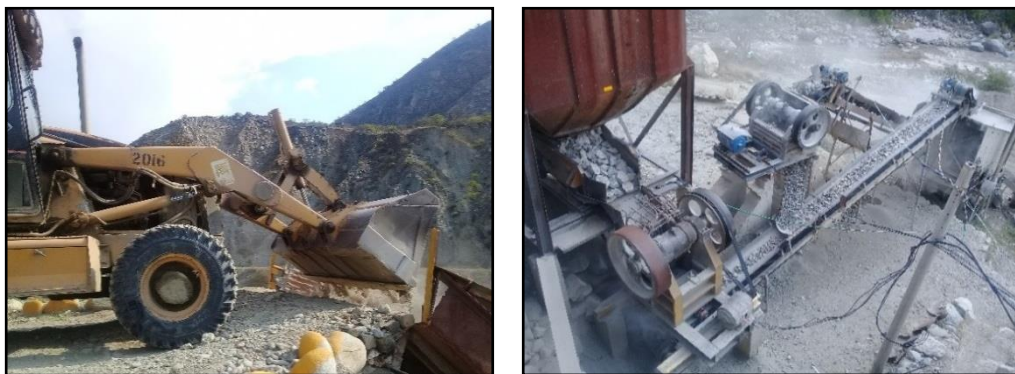
Figura 3. Traslado del material reciclado a la chancadora, donde se triturara.
