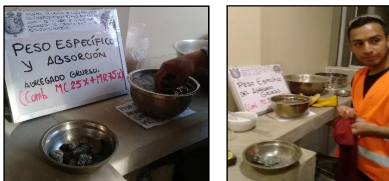
Figura 9. Secado superficial del agregado grueso como parte del ensayo de peso específico.
