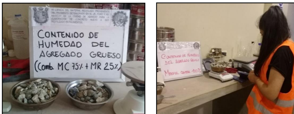
Figura 7. Cont. de humedad del agregado grueso 75% MC + 25% MR.
