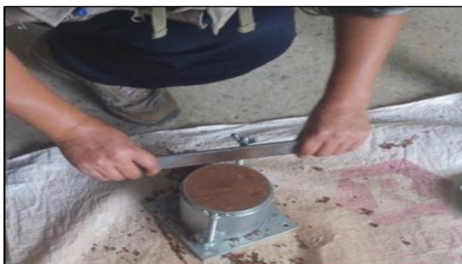
Figura 30: Enrase de espécimen para su posterior pesado.
