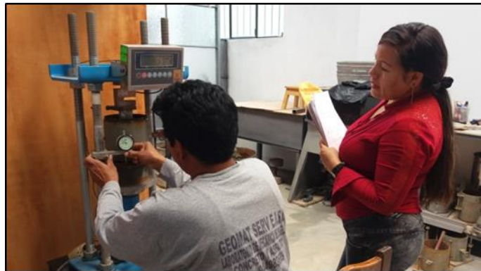
Figura 44: Resistencia a la penetración y toma de datos.
