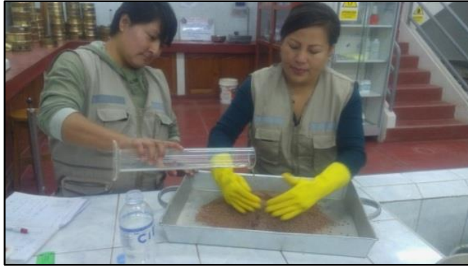
Figura 28: Preparación de la mezcla del suelo para ensayo de próctor modificado
