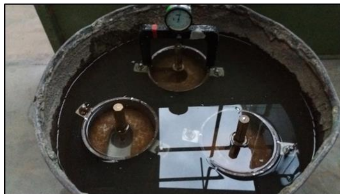
Figura 43: Lectura de expansión de la muestra.
