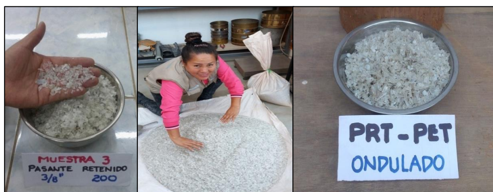
Figura 13: Plástico reciclado triturado - PET liso y PET ondulado
