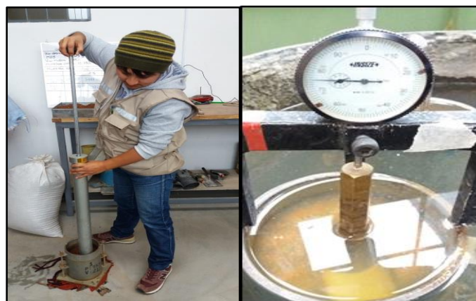
Figura 33: Compactado de la muestra y puesta en inmersión.
