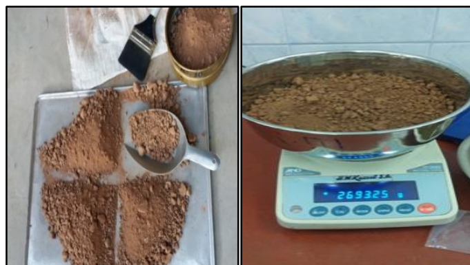
Figura 17: Cuarteo y pesado de la muestra
