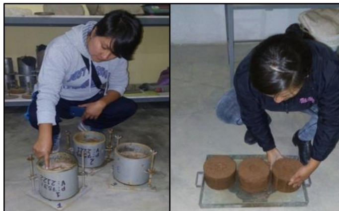
Figura 35: Muestras ya ensayadas y sacadas del molde de CBR.
