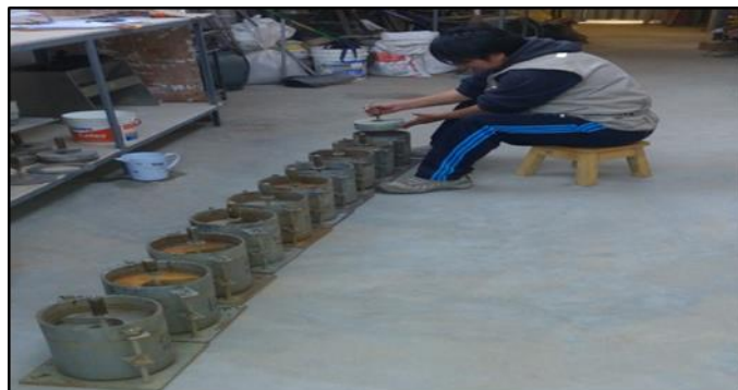
Figura 41: Especímenes listos para colocarlos a la poza.
