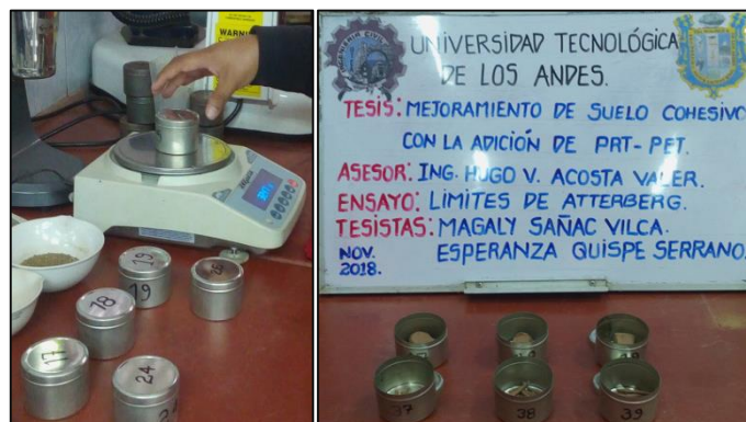
Figura 26: Toma de lectura de pesos tanto LL y LP sacados del horno.
