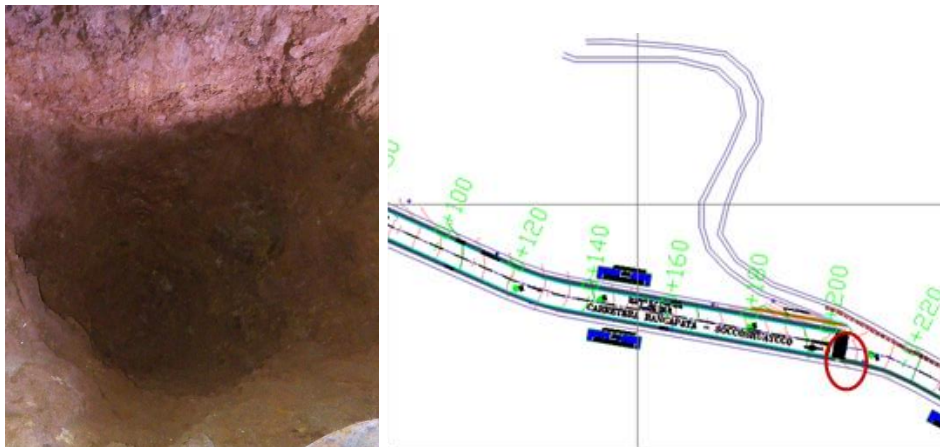
Figura 10: Localización y toma de muestra de la calicata 02 (C – 02)
