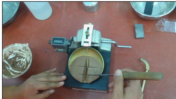
Figura 25: Verificación del cierre de la ranura a 13 mm (1/2 pulg).
