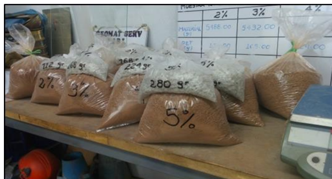
Figura 38: Suelo y PRT – PET pesado para ser mezclado.
