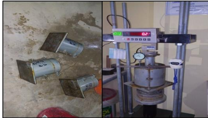
Figura 34: Escurrecimiento de la muestra y toma de datos de penetración.
