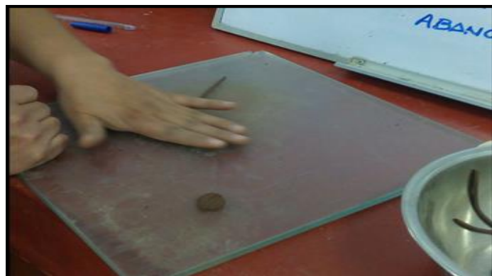
Figura 27: Ensayo de limite plástico con un diámetro aproximado de 3.2 mm.
