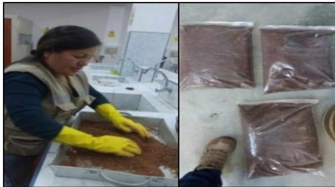
Figura 29: Mezclado suelo preparado y colocar en bolsas para su saturación.
