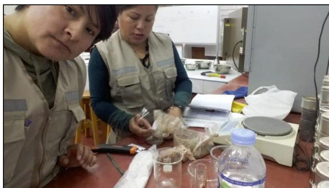
Figura 21: Colocación del aditivo defloculante a la muestra
