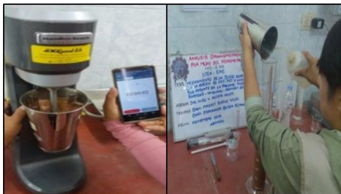
Figura 22: Batido de material con defloculante
