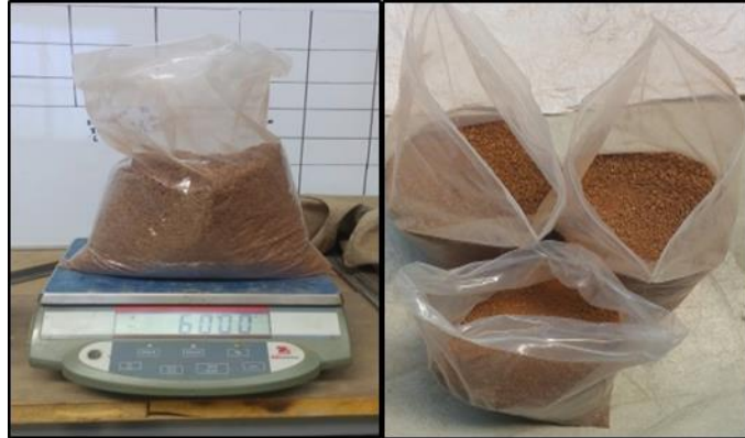
Figura 31: Cuarteo de material colocación en bolsas para ensayo.
