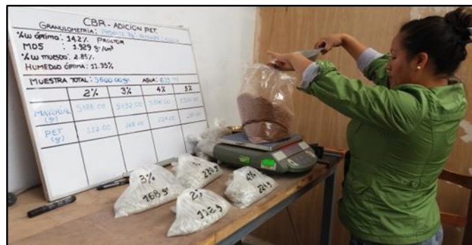
Figura 37: Preparación y pesando los materiales suelo – PRT-PET.
