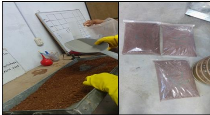
Figura 32: Mezcla del suelo y agua y saturación.
