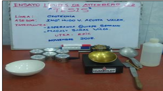
Figura 24: Equipos para la determinación límite líquido.
