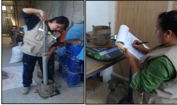
Figura 40: Compactación de los especímenes y toma de datos.
