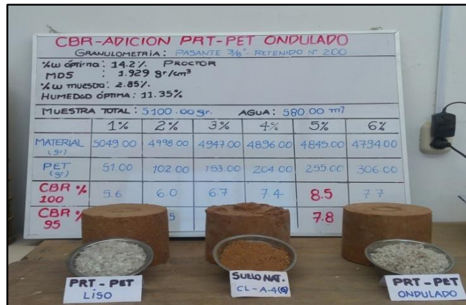
Figura 47: Muestras de suelo con PET-liso y suelo con PRT ondulado.
