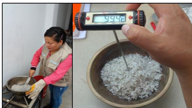
Figura 52: Temperatura de ondulado de material -PRT-PET liso.
