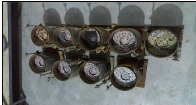
Figura 45: Muestras después del ensayo de penetración.
