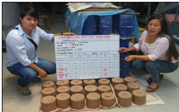
Figura 46: Muestras después del ensayo de penetración.
