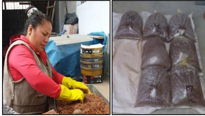
Figura 39: Mezcla y saturación del suelo con PRT – PET.
