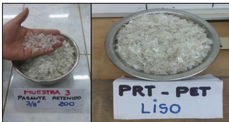
Figura 50: Muestra 03 - plástico reciclado triturado -PET.
