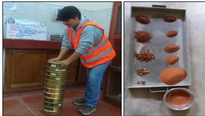
Figura 19: Tamizado manual de la muestra
