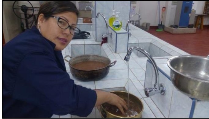
Figura 18: Lavado de material en la malla N° 200
