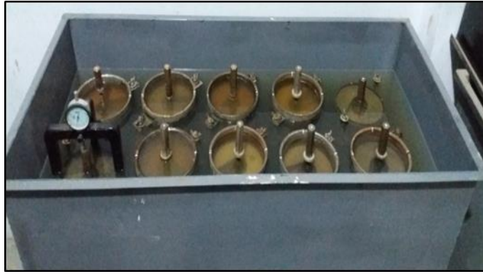
Figura 42: Inmersión de muestras de CBR durante 96 horas.
