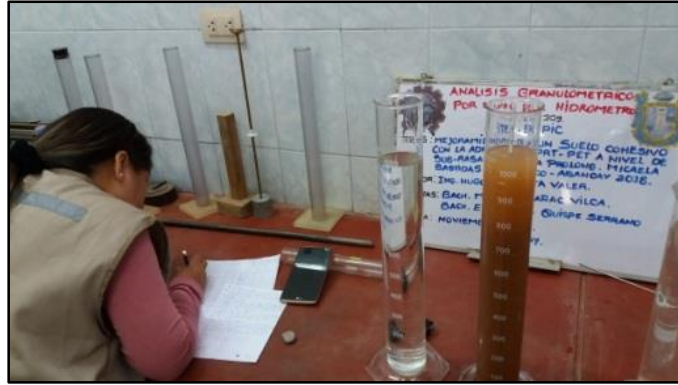
Figura 23: Toma de datos al 1', 2', 5', 15', 30', 60' hasta 1440''
