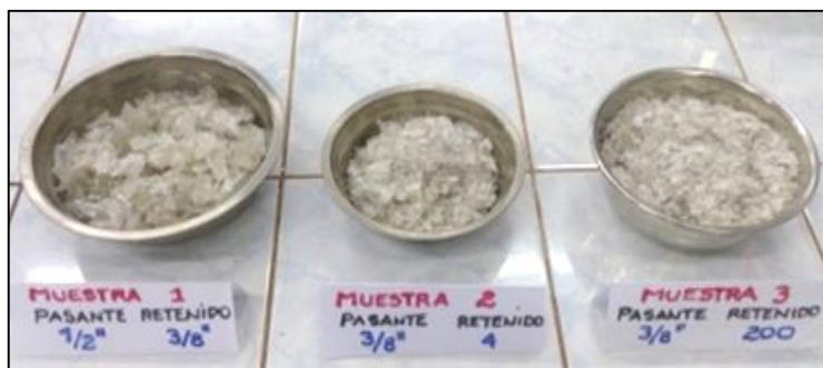
Figura 8: Selección de los tres tipos de granulometría de PRT – PET
