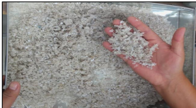
Figura 36: Plástico reciclado triturado - PET ondulado.
