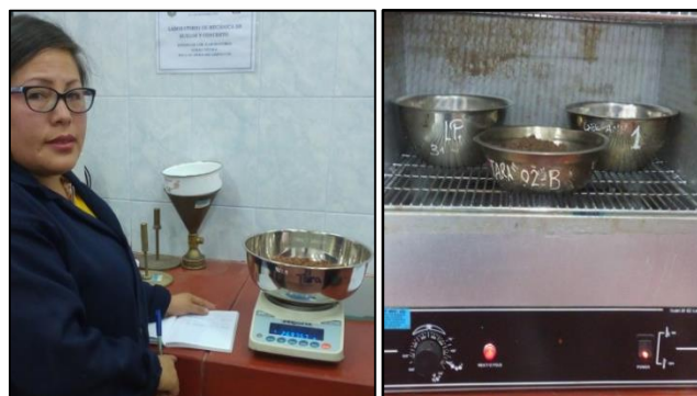
Figura 16: Lectura de pesos de la muestra y puesta al horno.
